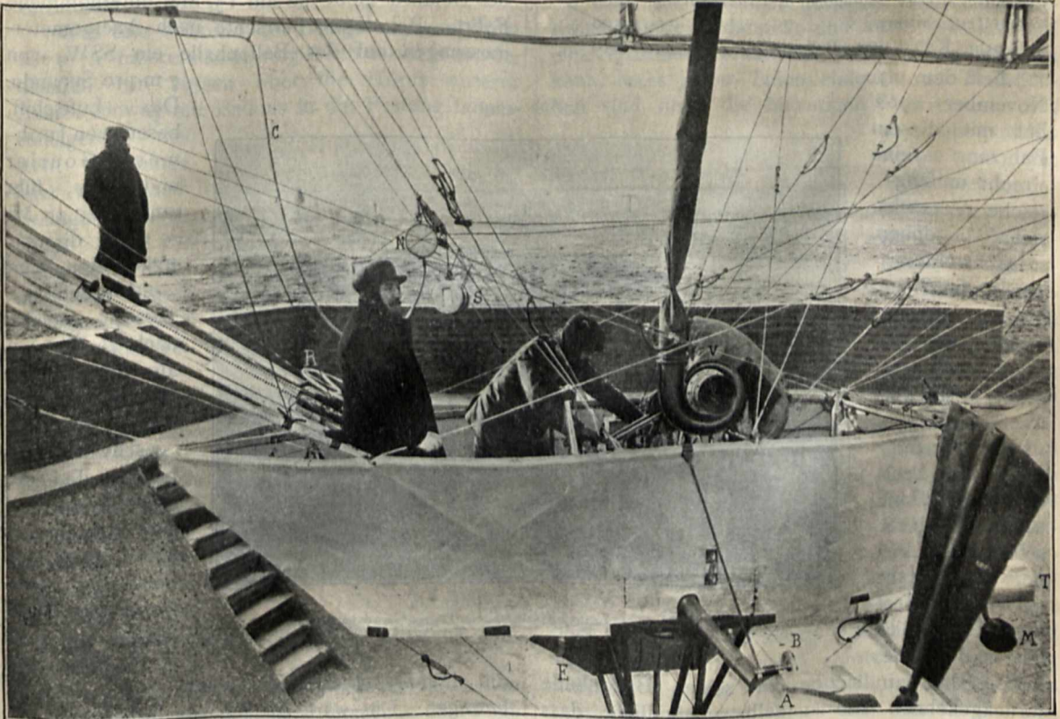
Die Gondel des Lebaudyschen Luftschiffes (Herbst 1902). A Schraubenkasten mit Räderwerk. M Gasauspuff. T Feuerschutzblech. E Benzintank. S Statoskop. R Steuerrad. N Gasdruck-Manometer. C Verbindungsschlauch. V Ventilator.
