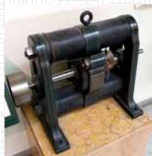
Fot. 8. Prądnicą Gramme'a służącą do zasilania pojedynczych lamp łukowych wg [11]
