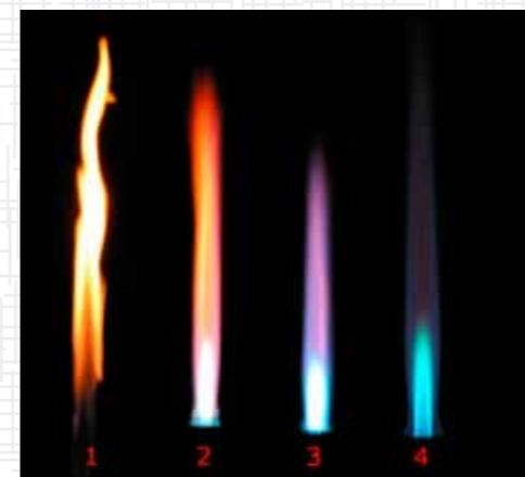
Fot. 1. Różne rodzaje płomieni w palniku Bunsena w zależności od ilości przepuszczonego przez zawór powietrza. 1 – zawór zamknięty, 2 – zawór otwarty w połowie, 3 – zawór niemalże w pełni otwarty, 4 – zawór całkowicie otwarty wg [2]
