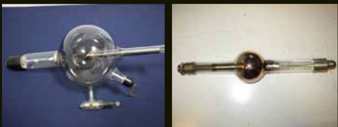
Jonowa lampa rentgenowska na Uniwersytecie Jagiellońskim (z lewej) oraz próżniowa lampa rentgenowska na Politechnice Gdańskiej
