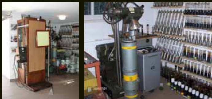
Kompletne aparaty rentgenowskie: z lewej aparat medyczny z 1943 r. polskiej produkcji Warsztat Elektromechaniczny – Czesław Skirucha, z prawej na przednim planie aparat medyczny, wojskowy firmy Picker – X-ray (USA), w tyle aparat do dyfrakcji rentgenowskiej
