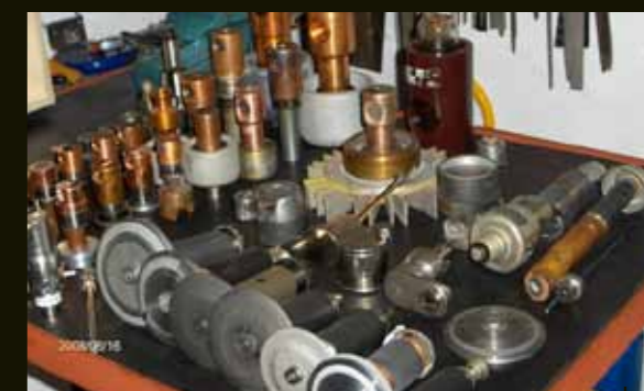
Fragmenty uszkodzonych podczas transportu lamp rentgenowskich
