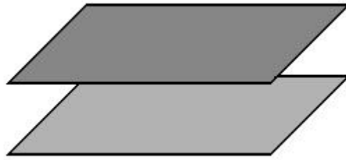
Rys. 3.10. Wycinek linii TEM w postaci dwóch równoległych, doskonale przewodzących płyt.
