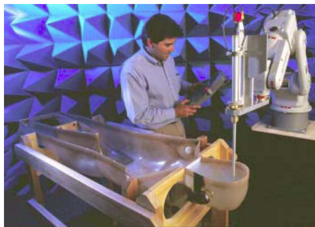
Rys. 4.3. Różne wersje fantomów do pomiaru współczynnika SAR: a) [6], b) [59].
