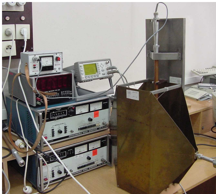
Rys. 3.9. Przykładowy zestaw służący do wzorcowania anten czujników PEM stosowany w Pracowni Ochrony Środowiska Elektromagnetycznego Politechniki Wrocławskiej.
