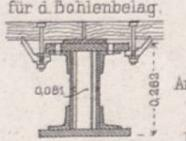
10. Horizontalschn. durch Winkeleisen c des doppelten Querträgers.
