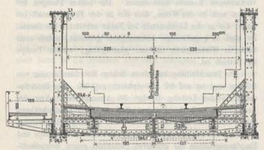
Abb. 13. Querschnitt durch den eisernen Ueberbau zur Ueberführung der Delitzscher Straße.
