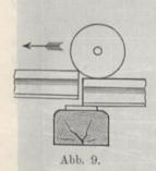
schlagenden Theile, also der Schienenfuß und die Unterlagsplatte, vorzugsweise der Zerstörung ausgesetzt. Untersuchungen an festen Stoßlagen innerhalb der Weichen an Stahlschienen der Form 100 mit guter Befestigung auf den Schwellen haben eine größere Abnutzung der Kopfenden gezeigt als an gleichen Schienen mit schwebender Stoßlage.
