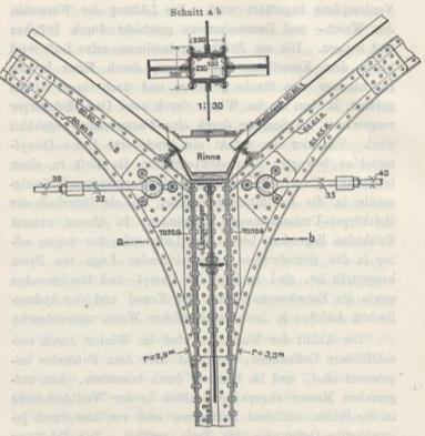
Abb. 5. Anschluß der Bögen an die mittlere Säule.
