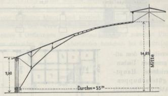
Abb. 8. Querschnitt des alten Daches.
