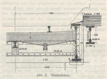
die Buckelplatten mit einer Betonschicht zu bedecken, die schwaches Gefälle nach den Auflagern erhält und mit Asphalt wasserdicht abgedeckt wird. Auf den Beton würde ein möglichst wasserdurchlassendes Material, am besten Steinschlag, aufzubringen sein, dessen Zwischenräume sich nicht so leicht durch Zufrieren verstopfen. Außerdem empfiehlt es sich, die Hauptträger möglichst hoch über die Bettung zu führen und für eine kräftig und schnell wirkende Wasserabführung hinter dem Auflager zu sorgen.
