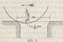
während des Aufschlags des Rades bei 90 km Zuggeschwindigkeit. Das Rad senkt sich nur 25 mm in die Stofslücke, und die abwärts gerichtete Aufschlaggeschwindigkeit beträgt hierbei nur 0,08 m,
