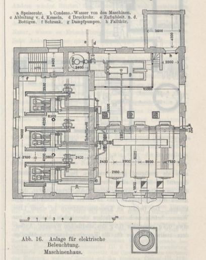
Die Dampfmaschinen und Kessel sind von Wolff in Buckau, die Dynanomaschinen, Accumulatoren, Lampen und Leitungen von Siemens u. Halske in Charlottenburg geliefert. Die Gesamtkosten der Maschinen-Anlage, der Lampen und Leitungen, jedoch mit Ausschluß der Gebäude und der Untermauerung der Kessel und Maschinen, betrugen rund 200 000 .M.
