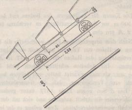
Die Eimer sind aus 10 mm starkem Eisenblech und haben einen besonders aufgenieteten Besatz mit vorn verstählter Schneide, dessen Stärke von 23 mm an den Seiten bis 33 mm nach der Mitte hin zunimmt. Die gußeisernen Walzen, auf welchen die Eimerkette läuft, haben bei 55 cm Durchmesser eine Länge von 1,20 m. Sie liegen in der Entfernung von 2,25 m. Die aus zwei schmiedeeisernen Trägern gebildete Eimerleiter hat in der Mitte eine Höhe
