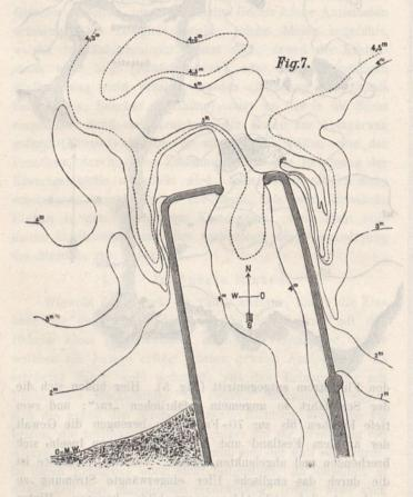
brechers, in dessen Schutz die Offenhaltung der Einfahrt durch Baggerung erfolgt, genöthigt wurde. — An den Hafendämmen zu Stolpmünde tritt der Schlauch beiderseits auf (Fig. 7), da die herrschenden Winde von der West-, die
