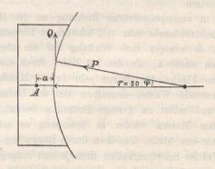
$P = p r d \varphi$ ,  $Q = P \sin \varphi = p \cdot r \cdot \sin \varphi d \varphi$  das durch Q um die Axe A des Polsters hervorgerufene Biegungs $moment = Q \cdot (a + y).$
