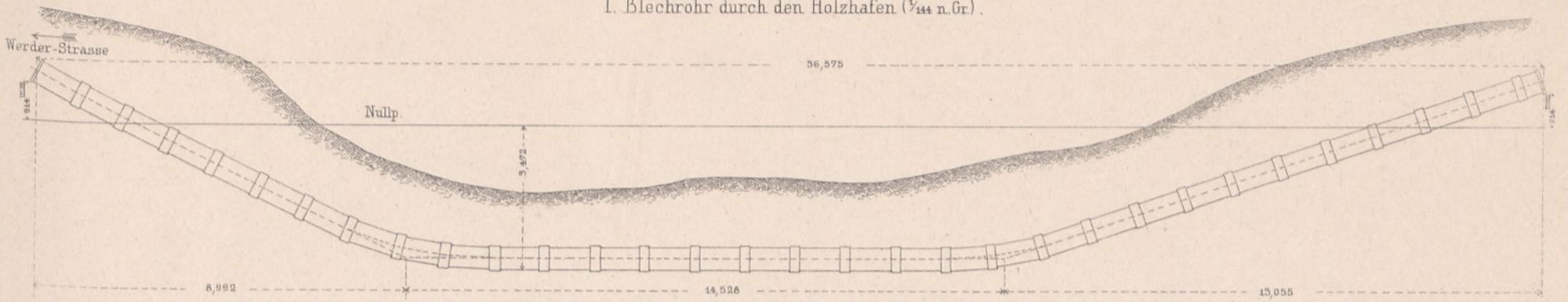
II. Blechrohr durch die grosse Weserbrücke (1/4 n.Gr.).
