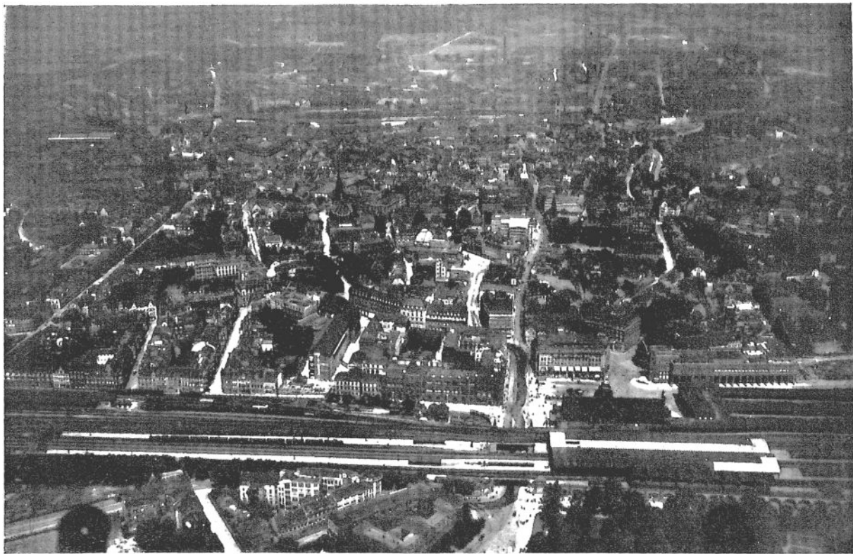
Abb. 8. Schrägaufnahme vom Hauptbahnhof Essen. Flughöhe 500 m, Neigung 45^\circ , Brennweite 18 cm. Aufgenommen von der Hansa Luftbildgesellschaft, Berlin
