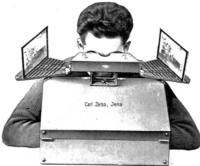
Abb. 28 Ansicht des Spiegelstereoskops im Gebrauch
