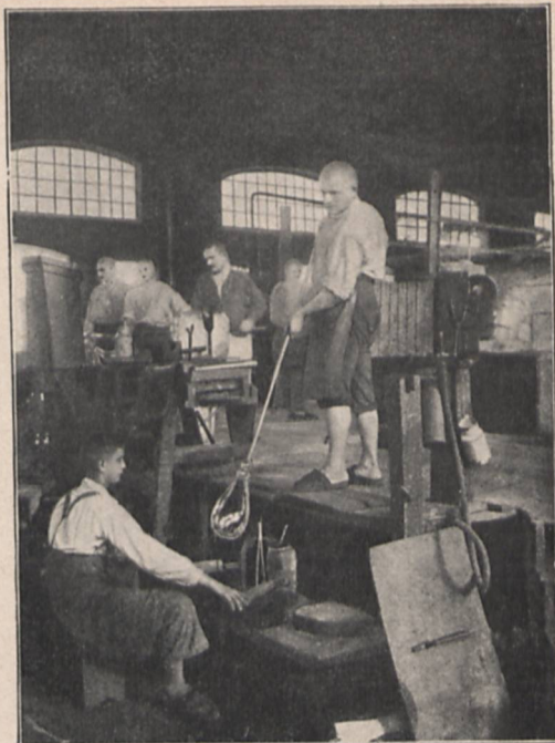
Abb. 9. Der Glasbläser will eben die noch weiche Glaskugel an der Pfeife in die offengehaltene Form geben.
