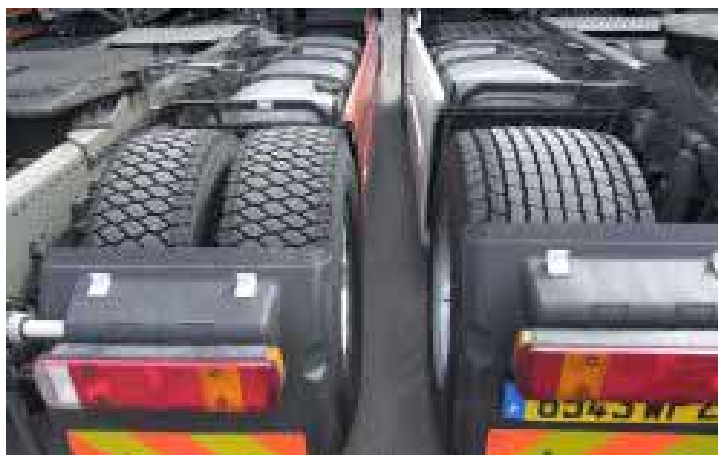
Rys. 4.4. Opony na oś napędową – opona tradycyjna „bliźniacza” i opona typu „super single drive” (materiały firmy Goodyear).
