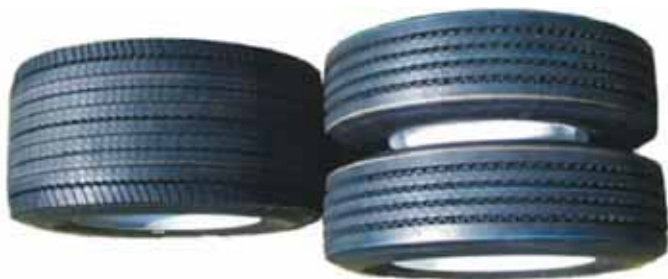
Rys. 4.3. Opona typu „Super Single” i dwie opony bliźniacze (materiały firmy Michelin).
