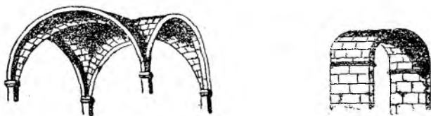
System sklepienia krzyżowego. System sklepienia beczkowego.
