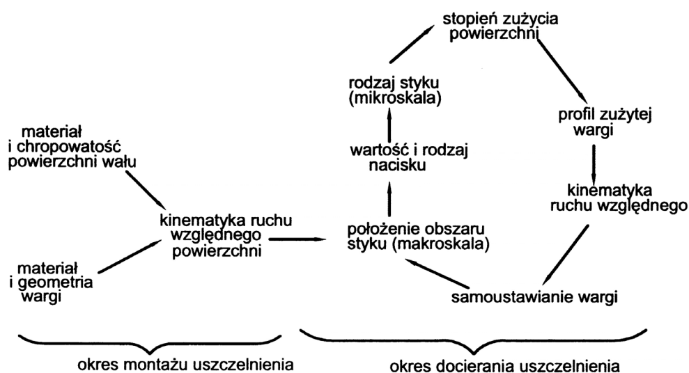
Rys. 100. Sekwencja zdarzeń występujących w okresie montażu oraz podczas docierania się powierzchni pary uszczelnienia wargowe-wał
