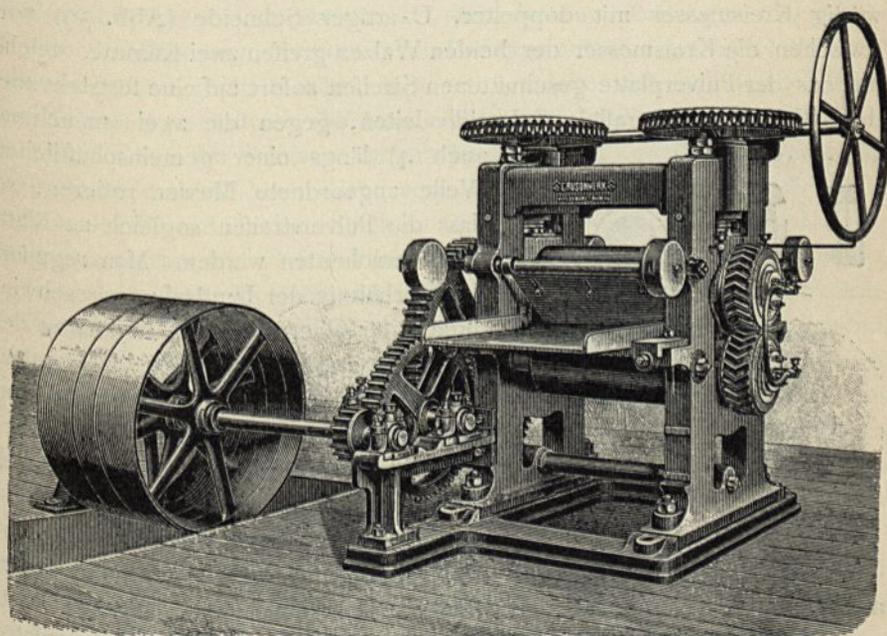
Abb. 36. Feinwalzwerk für rauchschwaches Pulver von F. Krupp-Grusonwerk.
