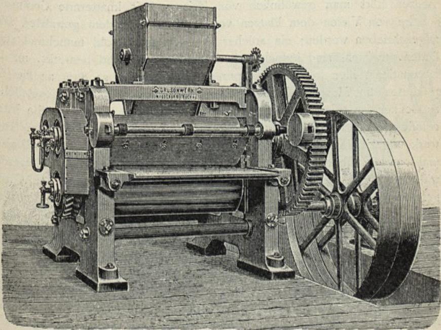
Abb. 35. Vorwalzwerk für rauchschwaches Pulver von F. Krupp-Grusonwerk.
