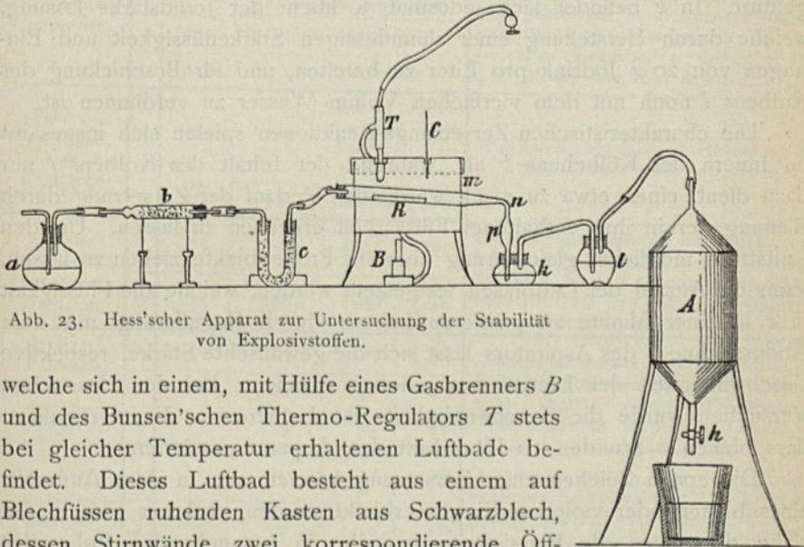
Abb. 23. Hess'scher Apparat zur Untersuchung der Stabilität von Explosivstoffen.
