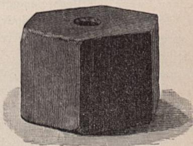
Abb. 8. Prismatisches Pulver C/75.
