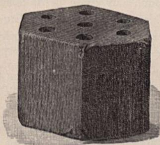
Abb. 7. Prismatisches Pulver C/68.
