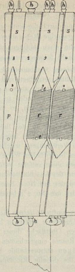
deren Bezeichnung jener der Federschiene entspricht. Diese Stücke werden mit je zwei kleinen Schrauben *t* auf den Federschiene befestigt, weshalb jedem Ausreibkolben noch ein Schraubenzieher beigegeben wird.
