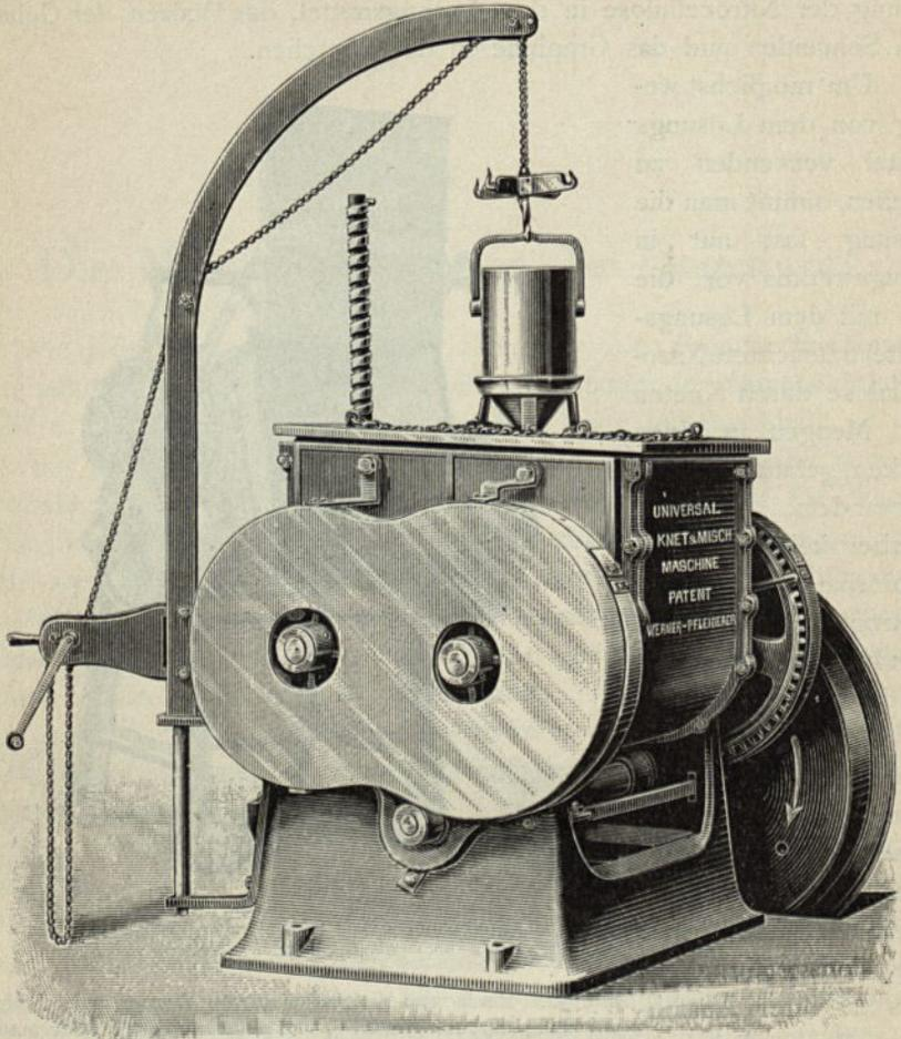
Abb. 33. Misch- und Knetmaschine für rauchschwaches Pulver von Werner und Pfeleiderer (mit aufgesetztem Deckel und Äthergefäß).
