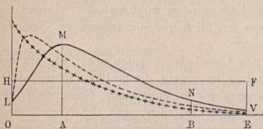
Abb. 3. Graphische Darstellung der Pulverarbeit im Rohre einer Feuerwaffe.
