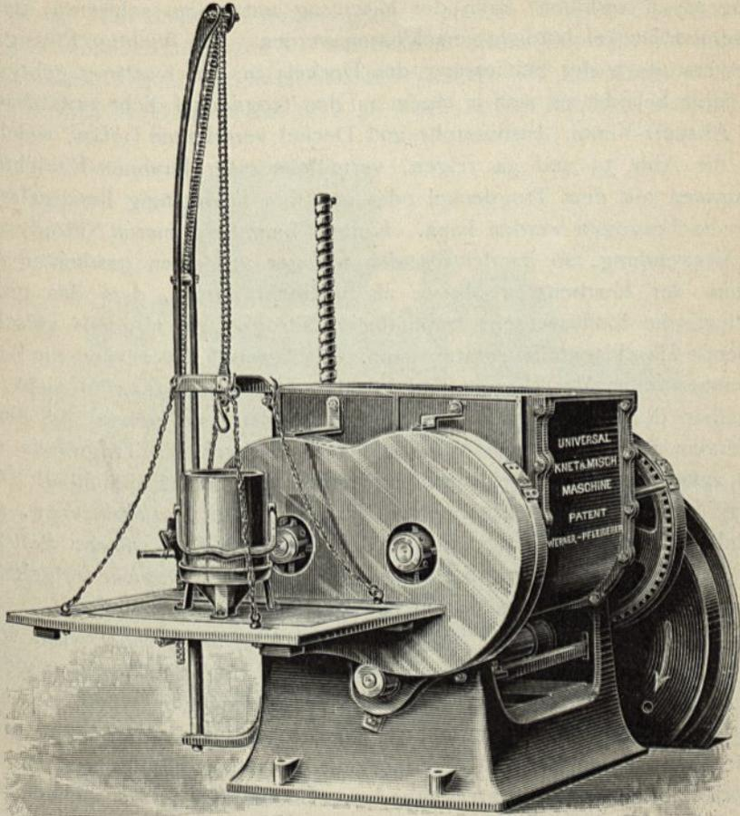
Abb. 34. Misch- und Knetmaschine für rauchschwaches Pulver von Werner und Pfeleiderer (mit abgenommenen Deckel und Äthergefäss).
