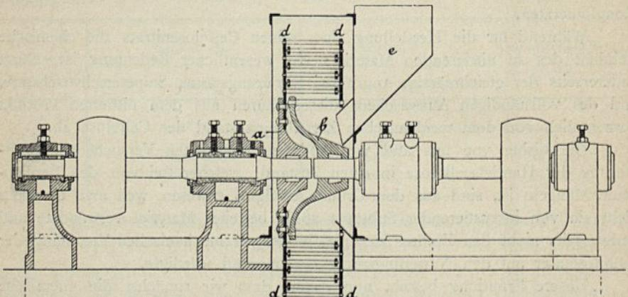
Abb. 40. Maschine der Zellstofffabrik Waldhof zur Vorbereitung von Cellulose für die Nitration.
