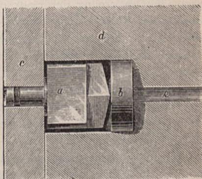
Abb. 6. Rodman's Gasdruckmesser
