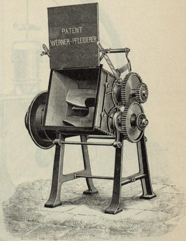
Abb. 32. Misch- und Knetmaschine von Werner und Pfeiderer (mit halbgekipptem Mischtrog und abgenommenem Rädermantel).
