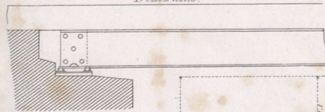
Auflager der äusseren Strassenbalken. Trottoirhöhe.
