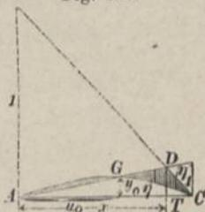
Einfluß-Ordinaten für  $Q_x'$  (s. Fig. 123, S. 160) nur die Ordinaten der Fläche  $M_1:l$  abzuziehen und erhält in Fig. 128 die Einflußfläche für  $Q_x$ .
