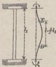
Ist der Stab an dem einen (unteren) Ende eingespannt, an dem anderen aber so gehalten, daß er hier eine beliebige Neigung annehmen, sich aber nicht aus der ursprünglichen Achse entfernen kann (Fig. 204), so ist zu dieser Führung eine besondere seitliche
