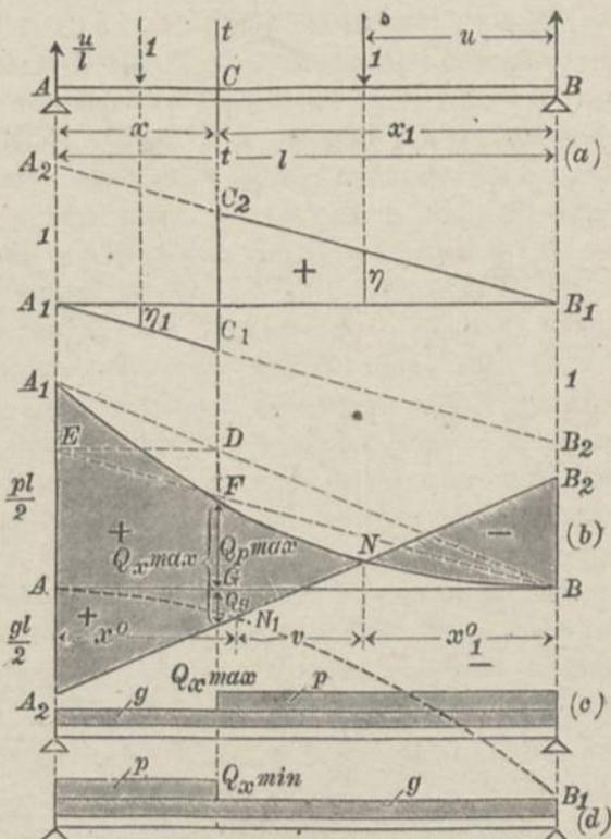
dessen Zweige  $A_1C_1$  und  $C_2B_1$  einander parallel sind, ist die Einflußlinie der Querkraft.
