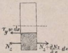
gerichteten Kräfte  $N_x$  aufheben,  $\tau_y \cdot w \cdot dx = \frac{\partial N_x}{\partial x} dx$  die Schubspannkraft auf die Länge  $dx$  des wagerechten Schnittes und diejenige für die Längeneinheit  $\tau_y \cdot w = \frac{\partial N_x}{\partial x}$ . Weil aber nach Gl. 2
