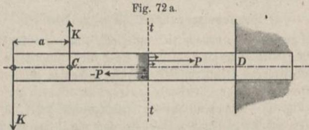
Ende durch ein Kräftepaar ergriffener Balken, zeigen auf der Strecke  $AB$  bzw.  $CD$  Beispiele reiner Biegungsspannungen.
