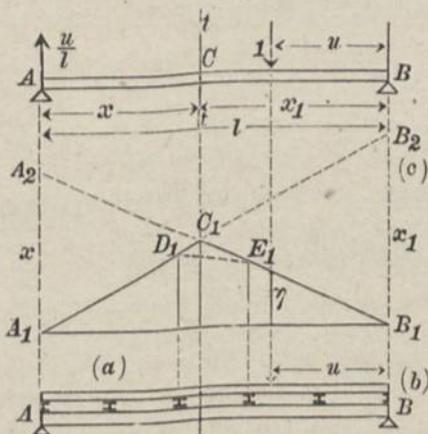
Last, d. h. mit  $u$ , veränderliche Einflussordinate derselben ist. Die lineare Gl. 1 ist die Gleichung der geraden Einflusslinie des Momentes in  $C$  für die Strecke  $BC$  des Balkens.
