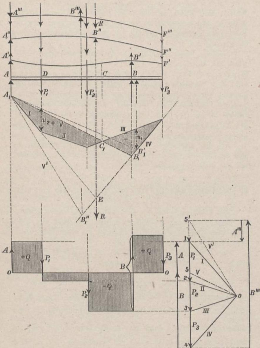
widerstand  $A$  wird gleich Null,  $B = 4-1$  gleich  $\Sigma \cdot K$ ; der Balken ruht balanzierend auf der Stütze  $B$ . Durch diese ist die Mittelkraft  $R$  aller Lasten gerichtet. Der positive Teil der Momentenfläche ist jetzt verschwunden, das Moment und die Krümmung des Balkens ist durchweg gleichsinnig, letztere konkav abwärts gerichtet (Biegungslinie  $A''B''F''$ ).
