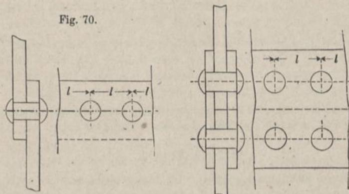
(Vergl. Fig. 70 u. 71.) Denkt man sich die Platten in Stäbe zerlegt, deren Breite gleich ist der Nietentfernung  $l$ , so bleibt die Rechnung grundsätzlich dieselbe.
