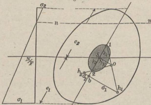
Die Widerstandsmomente in der Richtung der Kraftlinie sind also  $W_1 = k_1 F$  und  $W_2 = k_2 F$ . Damit erhält man die Randspannungen zu
