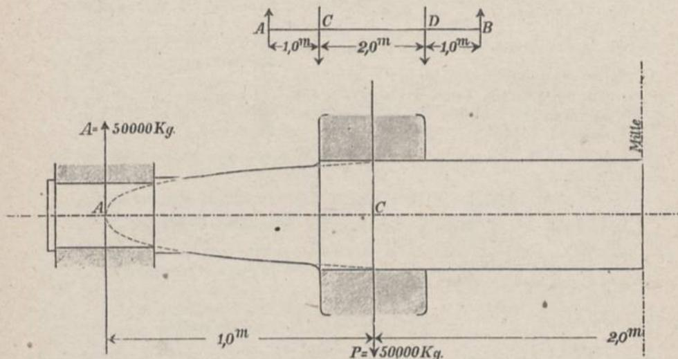
Die bei A und B wirkenden Lagerkräfte sind je gleich 50000 kg. Im Abstände  $x$  von A, bzw. B wirkt ein Biegemoment  $M_x = 50000 \cdot x$ . Der
