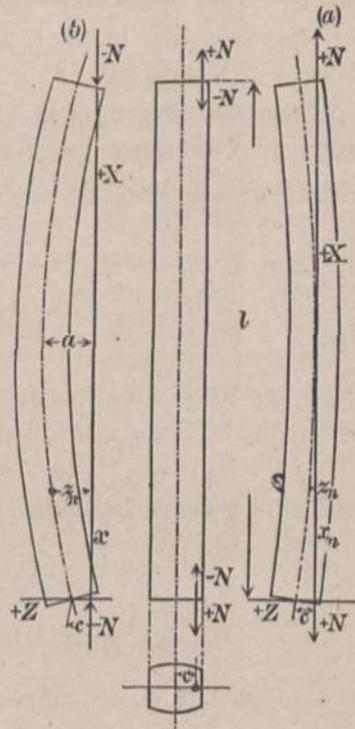
Stabenden auftretende Größtwert der letztern ist also eben so groß als er ohne Berücksichtigung der Biegung in allen Stabquerschnitten sein würde. Dieser Belastungsfall durch eine exzentrische Zugkraft erfordert daher für die Anwendung eine weitere Untersuchung nicht und wollen wir ihn deshalb hier ausscheiden.
