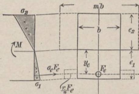
Ersetzt man in Gl. 18  $\frac{\sigma_1}{e_1}$  gemäß Gl. 14 u. 14a einmal durch  $\frac{\sigma_2}{m e_2}$  und ein anderes mal durch  $\frac{\sigma_e}{r y_e}$ , so folgt
