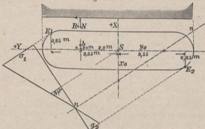
Normalkraft möge letztere zu  $N = -394\text{ t}$  ergeben. Der Pfeilerquerschnitt ist  $F = 15,14\text{ m}^2$ ,  $J_x = 73,00\text{ m}^4$ ,  $J_y = 4,8\text{ m}^4$ . Damit wird nach Gl. 8
