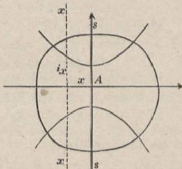
**b) Abhängigkeit des Trägheitsmomentes von der Richtung der Achse.**
