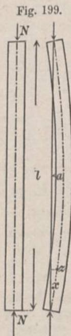
deren geometrischer Ausdruck im allgemeinen eine Wellenlinie ist; denn alle Punkte derselben, für welche  $\frac{x}{r}$  sich um  $2\pi$  bzw.  $2n\pi$ , also die Abscisse  $x$  um  $2r\pi$  bzw.  $2nr\pi$  unterscheidet, weisen gleiche Ordinaten  $z_n$  und gleiche Richtung der Biegungslinie auf. Das Maß  $2r\pi$  bezeichnet also die Länge einer ganzen und  $r\pi\lambda$  dasjenige einer halben Welle (Fig. 200).
