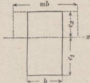
In fast gleich einfacher Weise lassen sich auch mit Hilfe des „reduzierten Querschnittes“ die Trägheitsmomente  $J_r$  für aus Recht-
