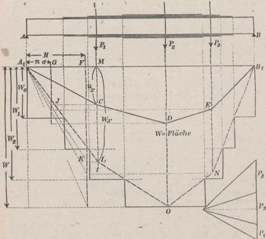
der Senkrechten durch  $C$ . Es ist dann  $FK = ML = W_x$ . In gleicher Weise werden die Eckpunkte  $O$  und  $N$  der polygonalen  $W$ -Linie gefunden. Die umschließende punktierte Stufenlinie stellt wieder die im herzustellenden Träger wirklich vorhandenen Widerstandsmomente dar und läßt erkennen, in welcher Erstreckung die einzelnen Lamellen anzubringen sind.
