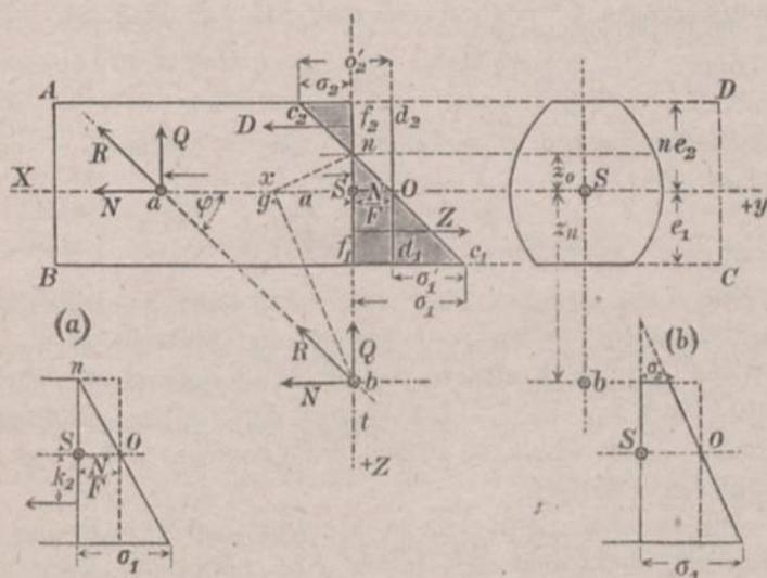
kraft  $R$  der Kräfte linksseits einer Schnittebene  $tt$  schliesse mit der Stabachse den Winkel  $\varphi$  ein. Der Stabquerschnitt sei von beliebiger
