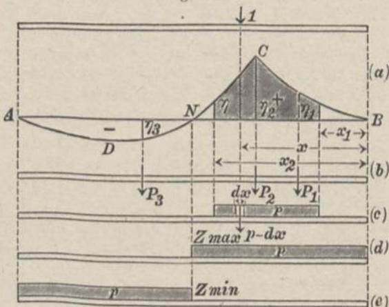
gleich Null oder negativ werden, die Einflußlinie die Nulllinie schneiden. Der Schnittpunkt  $N$  trennt dann Bereiche positiven und negativen Einflusses und man nennt ihn daher Belastungsscheide.
