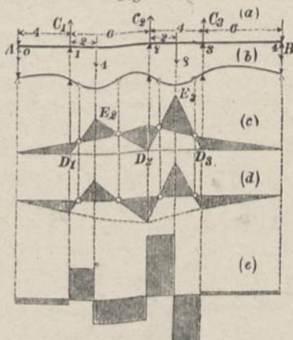
Als Probe gilt:  $-A - B + 4 + 8 = C_1 + C_2 + C_3$ . (Selbstverständlich hätte man die letzten beiden Auflagerdrücke  $C_3$  und  $B$  nach Berechnung der anderen auch mittels der Gleichgewichts-Bedingungen finden können.)
