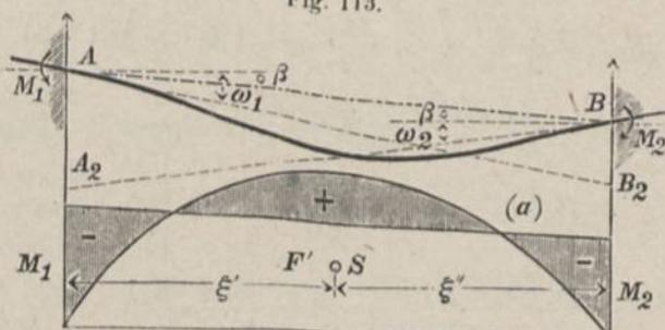
Denkt man sich nun die Balkenenden in den unter Zusammenwirkung der positiven Momente der Belastung und der negativen Momente  $M_1$  und  $M_2$  entstandenen Neigungen  $\omega_1$  und  $\omega_2$  festgehalten oder eingespannt, so hat die Einspannung die Momente  $M_1$  und  $M_2$  zu leisten.
