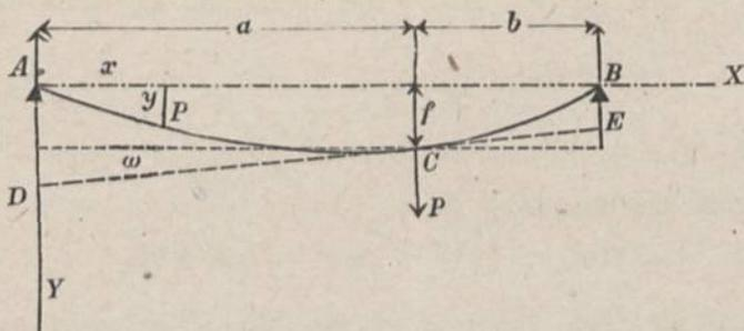
Balken nach eingetretener Krümmung bei  $C$  nach Richtung und Lage festgehalten und die Auflager  $A$  und  $B$  beseitigt, so würde die Krümmung verschwinden und die gerade Stabachse sich in die Richtung der Tangente  $DE$  mit der Neigung  $\omega$  gegen die Wagerechte einstellen. Der Punkt  $A$  gelangt dabei nach  $D$  und der Punkt  $B$  nach  $E$  und es würde sein  $AD = f + a\omega$  und  $BE = f - b\omega$ .
