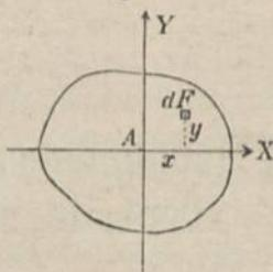
2. Das polare Trägheitsmoment, d. h. die Summe aller kleinsten Flächenteilchen, jedes multipliziert mit dem Quadrate seines Abstandes  $\rho$  von einem innerhalb der Ebene der Fläche gelegenen Punkte, als Pol. Es werde hinfort mit  $J_p$  bezeichnet und seine Entstehung ausgedrückt durch die Gleichung
