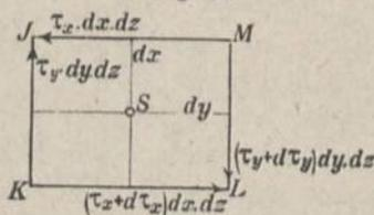
zu deren Durchschnittslinie auftretenden Schubspannungen sind einander gleich und haben gleichen Richtungssinn gegen jene Durchschnittslinie.
