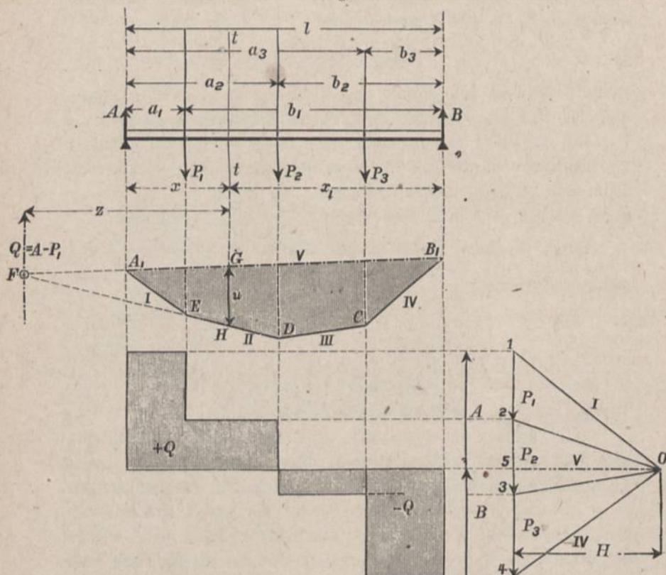
$M$  fällt stets mit einem Eckpunkt des Seilecks bzw. dem Angriffspunkt einer Last zusammen und zwar, wie aus der Figur leicht ersichtlich, mit derjenigen Last, bei welcher die Querkraft ihr Vorzeichen wechselt, vom Positiven zum Negativen übertritt. In dem Sonderfalle, wenn der Abschnitt  $u$  für zwei benachbarte Eckpunkte gleiche Größtwerte zeigt, die zwischenliegende Seilecksseite parallel ist der Schlußlinie des Seilecks, ist  $M$  zwischen den entsprechenden Lasten konstant.
