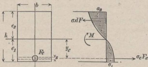
Umhüllung als sehr klein vorausgesetzt werden, so daß die Spannungen  $\sigma_e$  der Einlage als über deren Querschnitt  $F_e$  gleichmäßig
