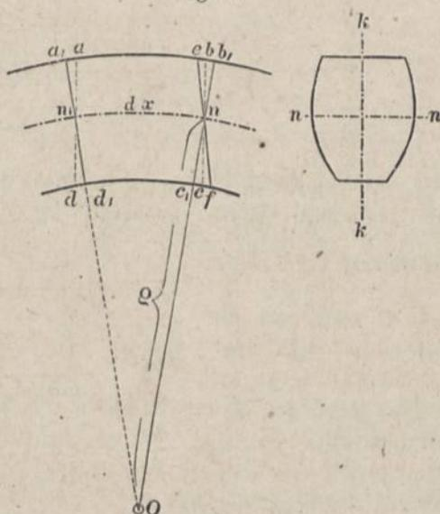
der vorausgesetzten Symmetrie der Querschnitte in Bezug auf die Kraftlinie  $kk$  (Schnittlinie der Querschnitts- und Kräfteebene) kann die Nulllinie  $nn$  nur rechtwinklig zu derselben gerichtet sein.
