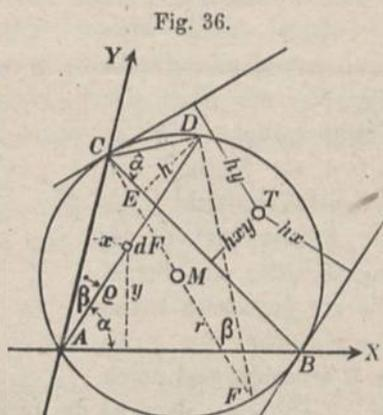
eine in Punkten  $D$  auf dem Kreisumfange angreifende, für alle Flächenteilchen  $dF$  gleichgerichtete Kraft und  $h$  als ihren mit der Lage von  $dF$  veränderlichen Hebelsarm an, so erscheint  $dC_{xy}$  als statisches Moment in Bezug auf die Sehne  $BC$ . Die Mittelkraft aller jener Kräfte ist dann
