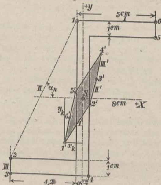
Für die Seite *III* ist  $\alpha_n = 90^\circ$ ,  $\operatorname{cotg} \alpha_n = 0$  und nach Gl. 8 a mit  $y = -5 \text{ cm}$ ,  $x = -4,6 \text{ cm}$
