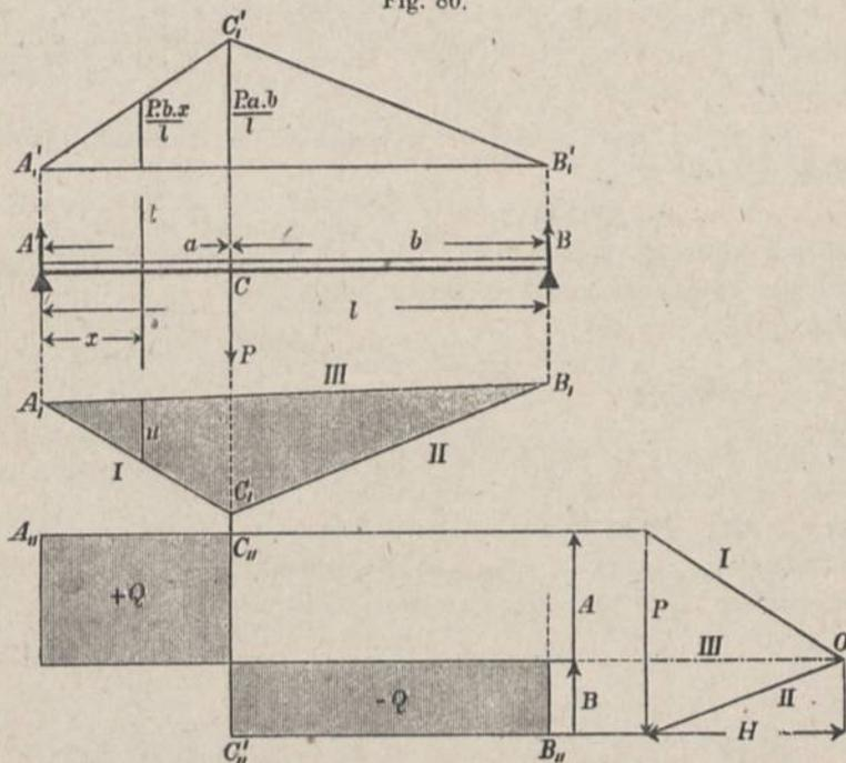
in der Verbindungslinie  $A_1 B_1$  die Schlusseite  $III$  des Seilecks. Der ihr parallele Polstrahl  $III$  schneidet auf  $P$  die Stützverstärkungen  $A$  und  $B$  ab.
