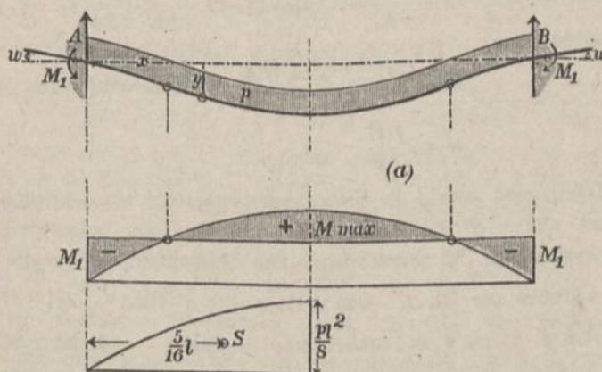
Parallelkräfte in einer Ebene handelt, nur zwei Gleichgewichtsbedingungen gegenüberstehen, so daß der Zustand des Balkens ein zweifach statisch unbestimmter ist.
