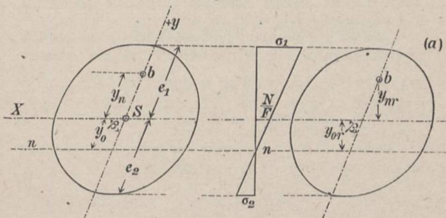
Verteilung der Normalspannungen im Querschnitt aus diesen gezogenen Schlüsse (vergl. S. 228 u. 229) lassen sich auch aus Gl. 12 ziehen. Für die Nulllinie erhalten wir die Gleichung
