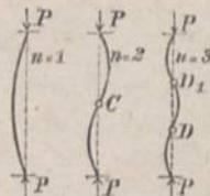
Ist der Stab daher nur an seinen Enden drehbar festgehalten, so wird er in einer halben Welle knicken; es ist  $n = 1$
