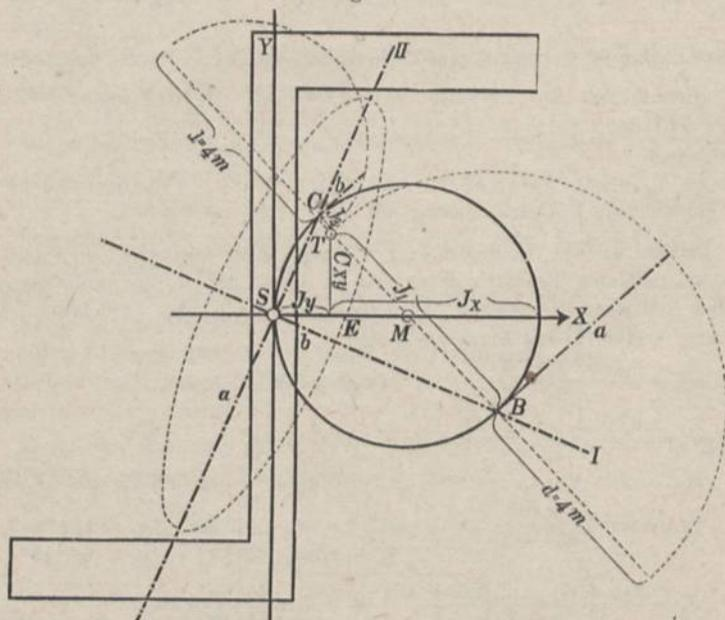
In Fig. 44 sind  $J_x$  und  $J_y$  auf der X-Achse zusammengetragen und im Punkte E das Centrifugalmoment  $C_{xy}$ , weil  $> 0$  als Lot in der Richtung der
