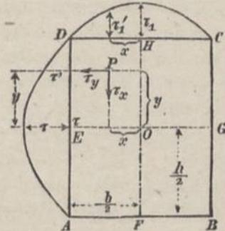
der Richtung der Seiten  $AD$  und  $CB$ , bzw.  $\tau_y$  in der Richtung der Seiten  $AB$  und  $CD$ , denn Gleitungen und Schubspannungen sind verhältnisgleich.
