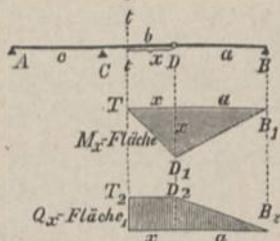
sich also mit diesem nach  $B$  hin gleichmäßig bis auf Null. Hiermit steht die Einflußfläche für  $Q_x$  fest (s. Fig. 132) und es wird
