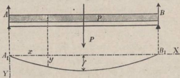
Der Stützdruck in  $A$  und  $B$  ist  $A=B=\frac{P}{2}+\frac{pl}{2}$  und das Biegemoment für einen Punkt  $P(x, y)$   $M_x = Ax - \frac{px^2}{2}$ . Dieses erzeugt eine Biegung konkav aufwärts nach der negativen  $Y$ -Richtung hin und ist daher negativ in die Grundgleichung der Biegelinie einzuführen. Es ist daher
