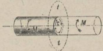
Die entstehenden Schubspannungen nennt man in diesem Falle Verdrehungs- oder Torsionsspannungen; das Material des
