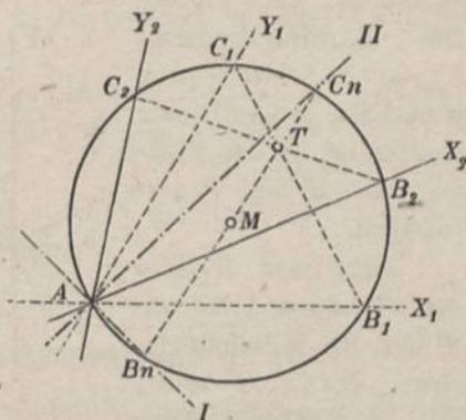
so bilden die durch die Schnittpunkte  $B_1$  und  $C_1$ ,  $B_2$  und  $C_2$  u. s. w. der einzelnen Geraden mit dem Kreise gehenden Achsen  $X_1 Y_1$ ,  $X_2 Y_2$  u. s. w. zugeordnete Achsen-paare und in ihrer Gesamtheit einen involutorischen Strahlenbüschel,
