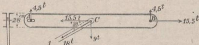
Die eintretenden größten Randspannungen  $\sigma_1$  und  $\sigma_2$  sollen berechnet werden. Die Zerlegung der angreifenden Kraft in eine lot- und wagerechte Seitenkraft ergibt für erstere  $18000 \cdot \sin 30^\circ = 9000$  kg und für letztere  $18000 \cdot \cos 30^\circ = 15500$  kg.
