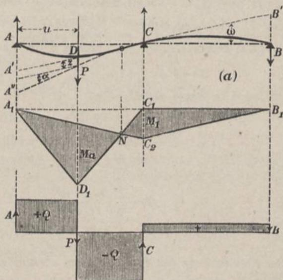
gleicher Höhe angenommen und der von der Belastung unabhängige Einfluß einer Senkung  $c$  der Mittelstütze soll nach den Ausführungen auf S. 127 u. 128 beurteilt werden.
