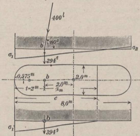
Beispiel 4: Ein im Grundriss 8 m langer und 2,0 m breiter, an den Enden halbkreisförmig abgerundeter Brückenpfeiler (Fig. 177), wird in seiner Mittel-
