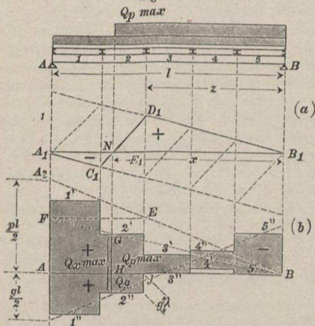
dafs für alle zwischen zwei Knotenpunkten  $C$  und  $D$  denkbaren Querschnitte dieselbe Einflußlinie und daher auch die gleiche Querkraft gilt. Bei der aus der Figur ersichtlichen Bezeichnung wird jetzt
