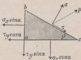
Mit  $\frac{d\sigma}{d\alpha}$  wird also auch  $\tau$  gleich Null. Wir erkennen daraus, daß für denselben Winkel  $\alpha$ , für welchen  $\sigma$  seinen Größt- und Kleinstwert annimmt,  $\tau$  verschwindet. Jene Größt- und Kleinstwerte von  $\sigma$  nennen wir die an der Schnittstelle  $a$  herrschenden Hauptspannungen und bezeichnen sie mit  $\sigma_1$  und  $\sigma_2$ . Durch Nullsetzung von  $\frac{d\sigma}{d\alpha}$  ergibt sich für den Winkel  $\alpha$
