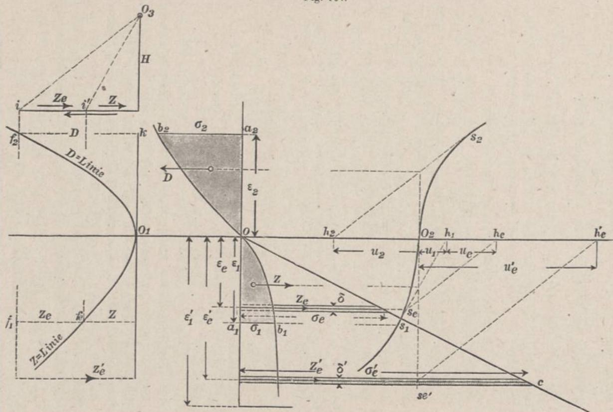
Lage der Biegungsachse im Querschnitt bestimmt. Die beiden Integralwerte der Gl. 7 drücken die Dehnungsfläche der Umhüllung und das Produkt  $\sigma_e \cdot \delta$  die der Einlage aus. Stellt man erstere beiderseits der  $\sigma$ -Achse wieder durch die sog.  $Z$ - und  $D$ -Linie dar, deren Ordinaten  $Z = \int_0^{\varepsilon_1} \sigma \cdot d\varepsilon$  und  $D = \int_0^{\varepsilon_2} \sigma \cdot d\varepsilon$  sind und bezeichnet  $\sigma_e \cdot \delta$  mit  $Z_e$ , so wird nach Gl. 7
