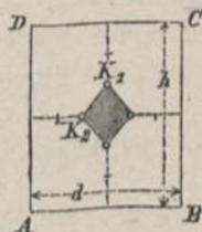
Die Richtungsziffer der Kernseiten ist gleich  $k_h:k_d = \frac{h}{6}:6 = h:d$ ; sie sind also parallel den Diagonalen.
