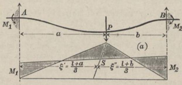
wagerechte Einspannung und gleiche Höheplage der Stützen wird außerdem  $\omega_1 = \omega_2 = 0$  und  $\beta = 0$ . Nach Gl. 15 u. 16 wird dann
