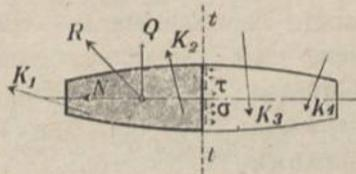
VI. Die Kraft  $R$  ist gleich Null, kreuzt die Stabachse senkrecht und liegt in unendlicher Ferne von ihr, d. h. die an den Stabenden angreifenden äußeren Kräfte bilden ein Kräftepaar, dessen Drehungsebene senkrecht zur Stabachse, also parallel der Schnittebene  $tt$  gerichtet ist. (Fig. 8.)
