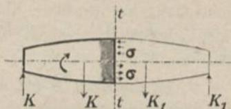
IV. Die Kraft  $R$  schneidet die Stabachse senkrecht in beliebigem Abstände von der Schnittebene  $tt$ . (Fig. 6.)
