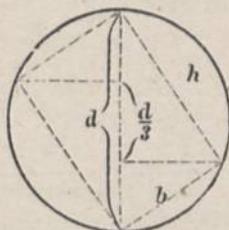
Für einen zylindrischen Stamm vom gegebenen Durchmesser  $d$  läßt sich der rechteckige Querschnitt mit größtem Widerstandsmoment in der aus der Figur ersichtlichen Weise auch leicht geometrisch konstruieren.
