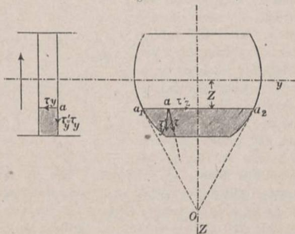
eine Parabel mit wagerechter Achse und der Pfeilhöhe  $\frac{3}{2} \frac{Q}{h}$ . Der Flächeninhalt der Parabel ergibt, wie es sein muß,  $\frac{2}{3} h \cdot \frac{3}{2} \frac{Q}{h} = Q$ .
