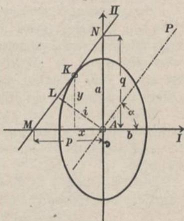
Dies ist die Gleichung der Ellipse in Linien-Koordinaten, d. h. die obige Beziehung zwischen den mit  $\alpha$  veränderlichen Abschnitten  $p$  und  $q$  und den Festlängen  $a$  und  $b$  bedingen ein System von Geraden  $MN$ , welche sämtlich Tangenten an eine Ellipse mit den Halbachsen  $a$  und  $b$  sind, diese Ellipse also umhüllen.
