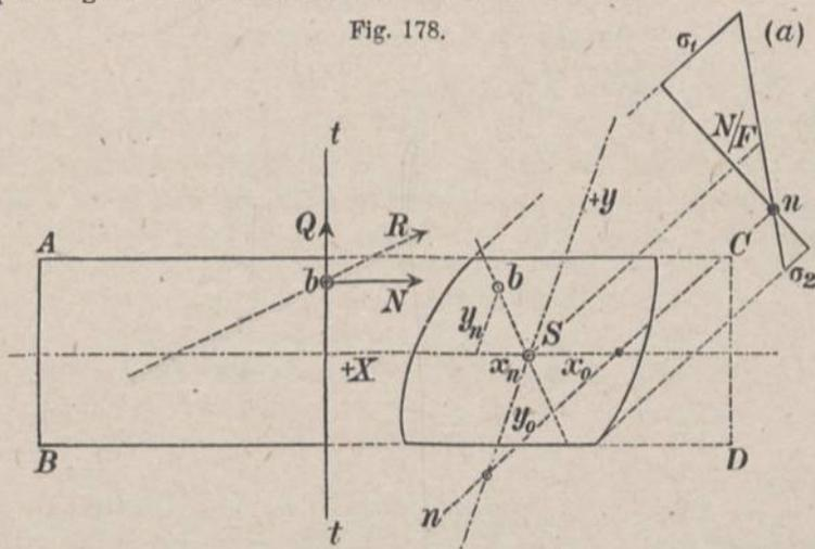
Denken wir sie uns in den einzelnen Querschnittspunkten als Ordinaten senkrecht zur Schnittebene aufgetragen, so erfüllen ihre Endpunkte eine Ebene (vergl. S. 228), deren Gleichung in Bezug auf ein dreiachsiges, mit zwei Achsen  $X$  und  $Y$  in die Schnittebene fallendes Koordinatenkreuz, im allgemeinen lautet:
