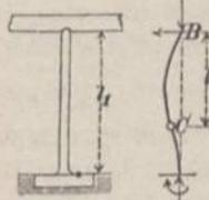
wird. Man kann hiernach auch auf diesen Fall die Grundformeln I, II und III anwenden, nur muß als Grundlänge  $l$  die Strecke  $BC = \frac{l_1}{\sqrt{2}} = 0,707 l_1$  eingeführt werden. (Der Wendepunkt  $C$  liegt etwas tiefer als der untere Drittelpunkt.) Die Tragfähigkeit ist in diesem Falle doppelt so groß wie in dem Grundfalle.
