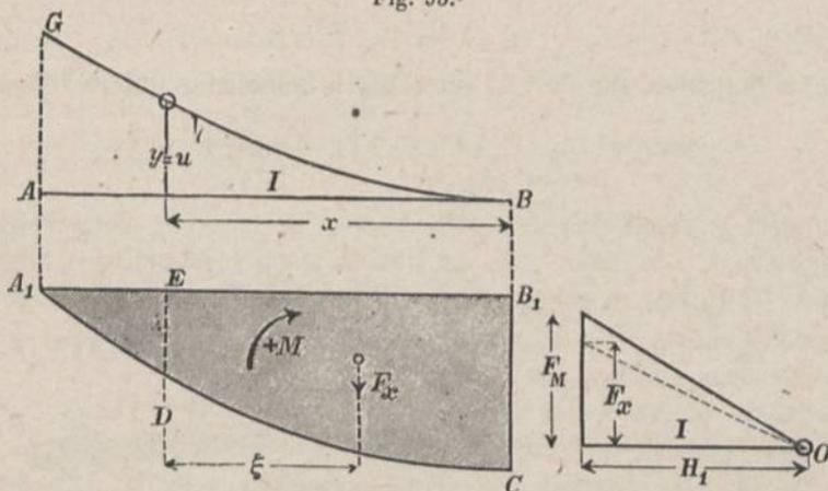
ist bei den aus der Figur ersichtlichen Bezeichnungen und wenn man die Biegelinie auf ein rechtwinkliges Achsenkreuz bezieht, dessen  $X$ -Achse mit der ungekrümmten Stabachse  $AB$  (Nullpunkt in  $B$ ) zusammenfällt, für irgend einen Punkt  $(xy)$  der Biegelinie
