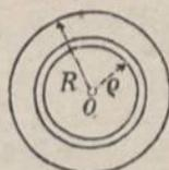
Für den kreisringförmigen Querschnitt ist nach Gl. 30 S. 22  $J_p = \frac{\pi}{2} \cdot (R^4 - r^4)$ , also für den hohlzylindrischen Stab
