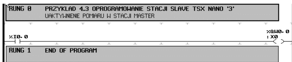
Rys. 4.32. Oprogramowanie stacji slave '3' na magistrali rozszerzenia (TSX 07 Nano)
