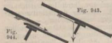
lassen. Die Fig. 943, 944 zeigen, wie das Wasser in den Innenraum abtropft und bezw. wie dasselbe bequem nach aussen geführt werden kann. Zwischen das Blech und die dasselbe unterstützenden Eisen sollte, auch selbst wenn beide mit einander vernietet werden, ein schlechter Wärmeleiter, z. B. ein in Mennige-Kitt getränkter Leinwand- oder ein Tuchstreifen gelegt werden. —
