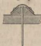
Eine andere Deckungsart, diejenige mit Falzverbindungen zwischen den Bahnen, unter Weglassung der Leisten, ist weniger haltbar als die Leistendeckung, weil an den scharfen Umbiegungen der Falze leicht Brüche eintreten und die Pappe in den Falzen sich auch leichter enttheert.
