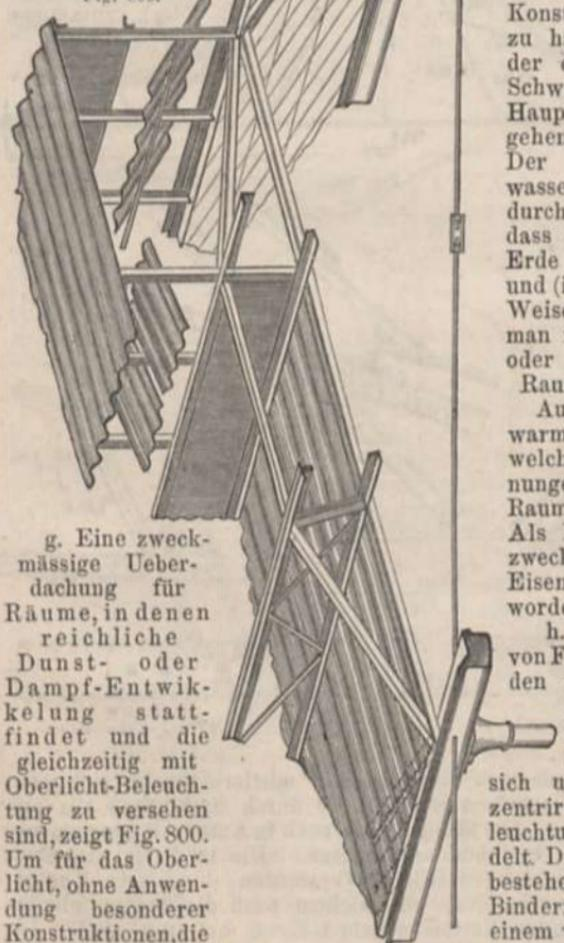
g. Eine zweckmässige Ueberdachung für Räume, in denen reichliche Dunst- oder Dampf-Entwicklung stattfindet und die gleichzeitig mit Oberlicht-Beleuchtung zu versehen sind, zeigt Fig. 800. Um für das Oberlicht, ohne Anwendung besonderer Konstruktionen, die erforderliche stär-
