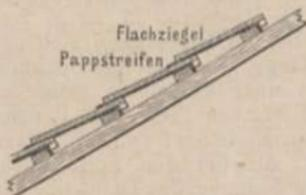
die parallel der Traufe gelegt werden. Indessen hat man dann eigentlich ein Doppeldach, das zur Hälfte aus Pappe, zur anderen Hälfte aus Flachziegeln hergestellt ist und hierbei freilich eine besondere Leichtigkeit besitzt. Eine häufige Anwendung hat diese Dichtungsart aus Gründen, die auf der Hand liegen, nicht gefunden.
