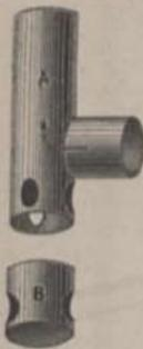
Durch die Drehung der Kapsel kann man den Ausschnitten eine solche Stellung geben, dass die Zimmerluft freien Eintritt in das Rauchrohr erhält oder aber von demselben abgesperrt wird. Sperrung findet jedenfalls beim Anzünden des Feuers und für so lange statt, als der Ofen seine ganze Leistungsfähigkeit entwickeln soll; bei allen anderen Zuständen kann das Rauchrohr ganz oder theilweise geöffnet werden. —
