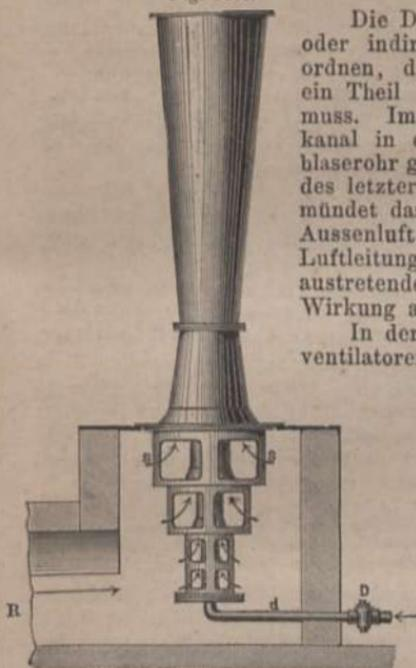
In der beigegebenen Skizze Fig. 1417 bezeichnen *S* die Saugeöffnungen, *d* das Dampfrohr mit dem Dampfventil *D*, *R* den Kanal für die abzuführende Luft. Dass der Ventilator nicht als Druckventilator (für das Pulsionsssystem) verwendbar ist, ersieht sich von selbst. —
