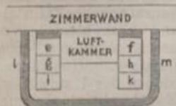
Kacheln, durch welche die Zimmerluft in den Hohlraum zwischen eisernem Aufsatz und Kachelmantel eintritt, um, erwärmt, oben durch den durchbrochenen Fries in das Zimmer zurück zu strömen. Die Aussenluft wird durch Oeffnungen im Fussboden oder in der Zimmerwand am Fusse einer Luftkammer Fig. 1310 zugeführt, erwärmt sich an der Rückseite des Feuerherdes und der Feuerzüge im Unterofen, sowie an den Rückseiten des eisernen Oberofens, und strömt alsdann durch den durchbrochenen Fries ins Zimmer. —
