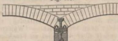
vor, so legt man bei Längen bis zu 4<sup>m</sup> und mangelnder Konstruktionshöhe 2 Schienen neben einander (Fig. 604), zwischen die man zur nothwendigen Absteifung 2 Ziegel-Flachschichten spannt; bei grösserer Länge, bis zu 5,75<sup>m</sup> etwa, wählt man die Konstruktion Fig. 605.
