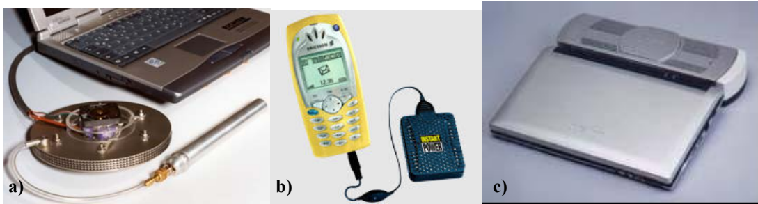
Rys. 1.3 Przykłady zastosowań ogniw paliwowych do zasilania urządzeń przenośnych, a) komputer przenośny zasilany prototypowym ogniwem polimerowym, b) ładowarka telefonu komórkowego zasilana ogniwem metanolowym, c) komputer przenośny z wbudowanym zasilaniem na bazie polimerowego ogniwa paliwowego [10, 11]
