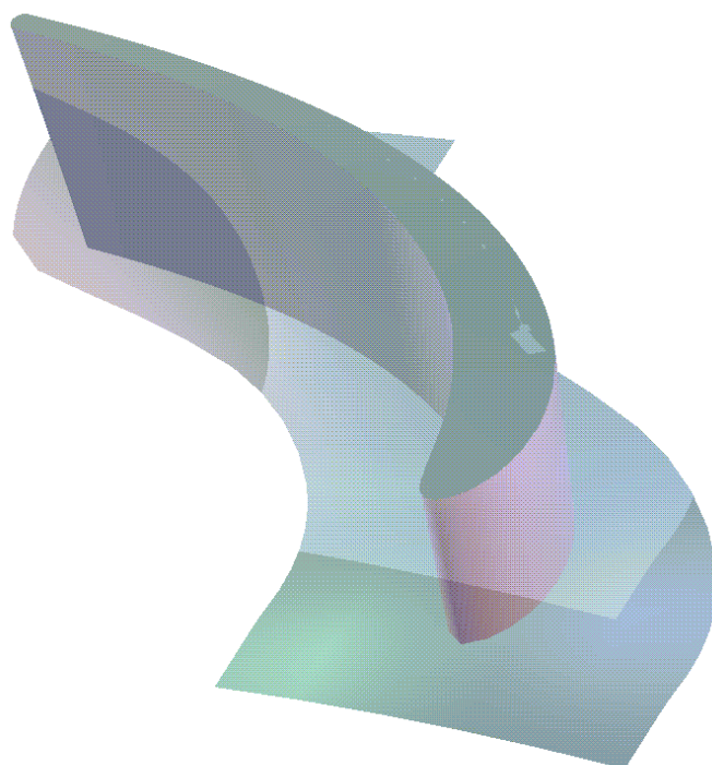
Rys. 6.15. Trójwymiarowy widok zamodelowanego kanału przepływowego wirnika
