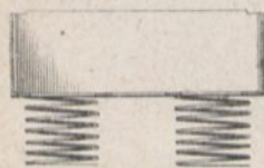
Fig 12. Schmierpolsterkästchen v.d Köln-Mindener E.B.
