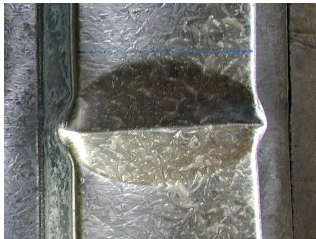
Rys. 2.7. Zgięciowy załom plastyczny – widok z góry
