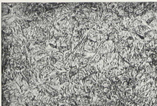
Rys. 25. Mikrostruktura powierzchni stali MFM i W3, hartowanych w wodzie o temperaturze 20°, 50°, 70° i 80° C. Temperatura hartowania 800°.
