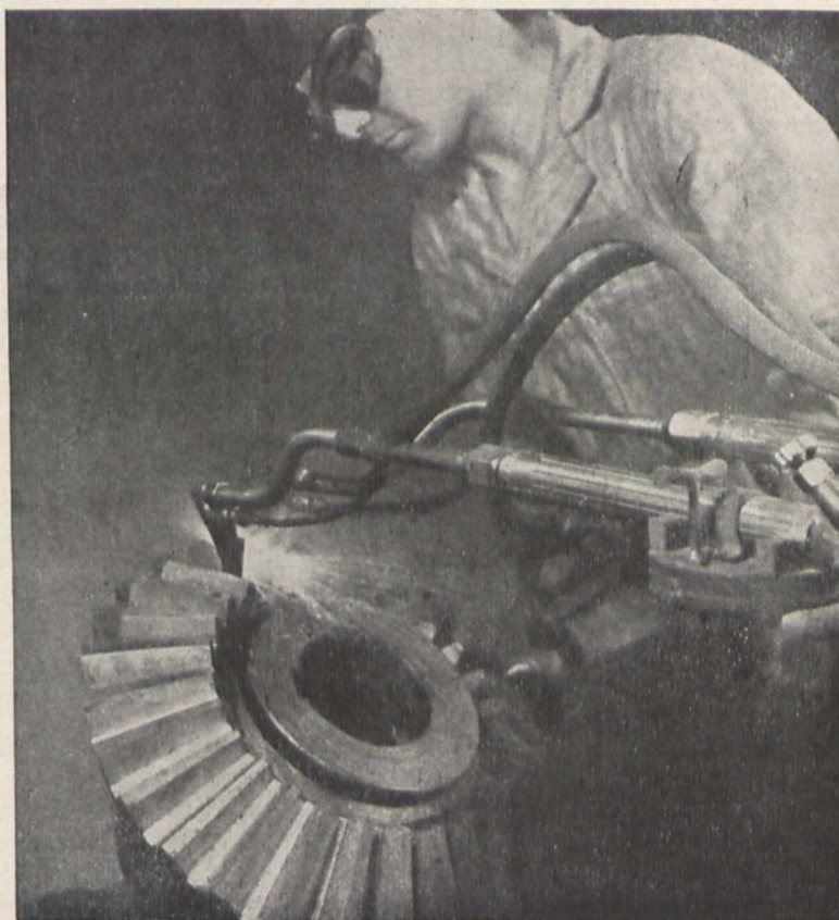
Rys. 5. Utwardzanie płomieniem zębów koła zębatego.
