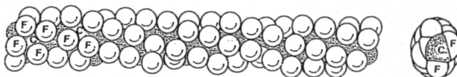
Rys. 25. Struktura molekularna policzterofluoroetylenu
