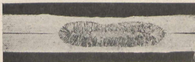
Rys. 32. Przekrój blach spawanych punktowo (wg Z. Mkde 28 (1936), str. 253).
