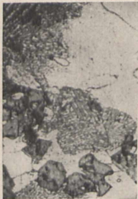
Rys. 21. Stop Mg Al 10 Si-L hartowany od 380°, odpuszczany w 250°.
