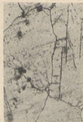
Rys. 14. Stop MgAl 6Sn - 6 hartowany od 400° w wodzie.
