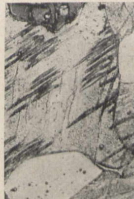
Rys. 19. Stop MgAl10Si-L hartowany od 420°, odpuszczany w 150°.
