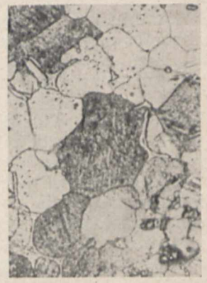
Rys. 18. Stop MgAl10Si-L hartowany od 420° odpuszczany w 150°.
