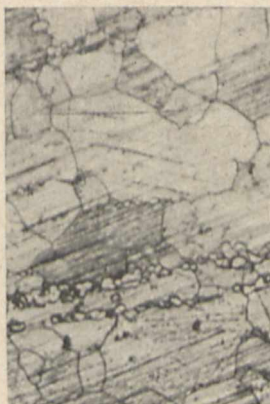
Rys. 13. Stop MgAl 10 - K po zahartowaniu od 400° w wodzie.
