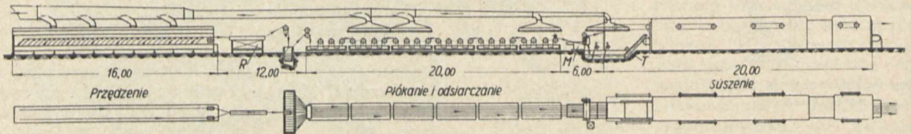
Rys. 12. Schemat aparatury do wytwarzania sztucznego włókna ciętego firmy Barbison, Włochy.
