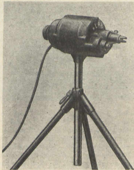
Rys. 1. Silnik elektryczny przenośny, ustawiony na trójnożu.
