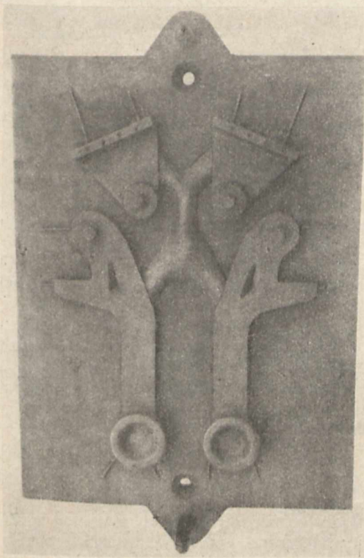
Rys. 11a. Odlewy maszynowe formowane bez nadlewów.
