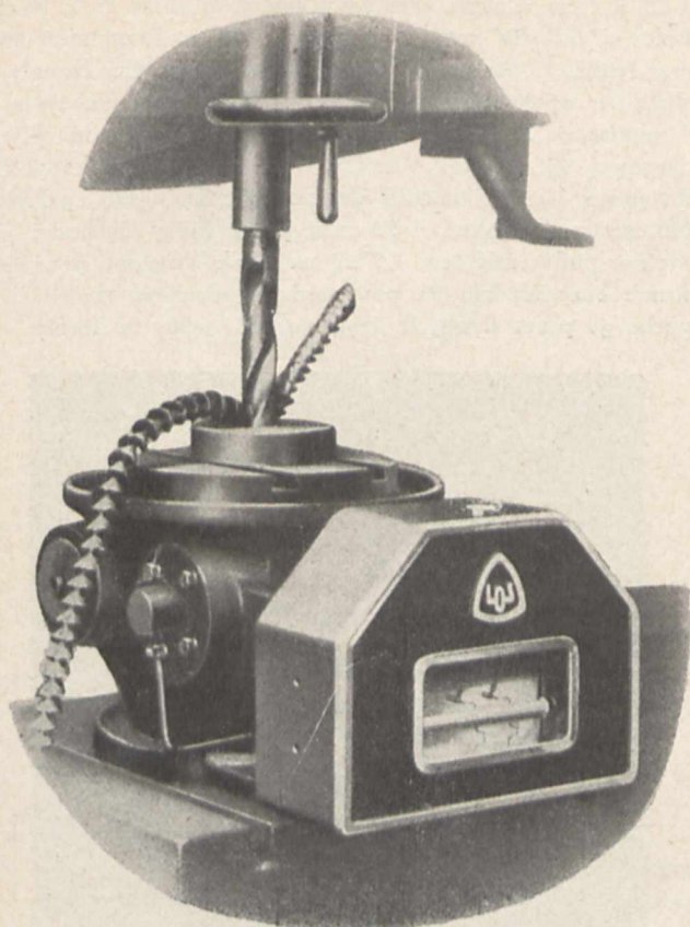
Rys. 12. Dynamometr hydrauliczny do pomiarów sił i momentów wiercenia (ewent. rozwiercania i gwintowania).
