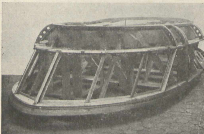
Rys. 15. Przyrząd drewniany do montażu i spawania przedniej części pudła.
