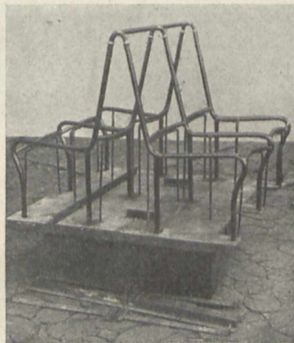
Rys. 16. Przyrząd do montażu i spawania siedzeń.
