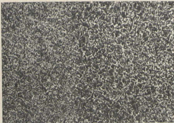
Rys. 19. Warstwa przejściowa (2 mm głęb.) spoiny jednowarstwowej spawanej elektrodami „CB”. Pow. 75 X.
