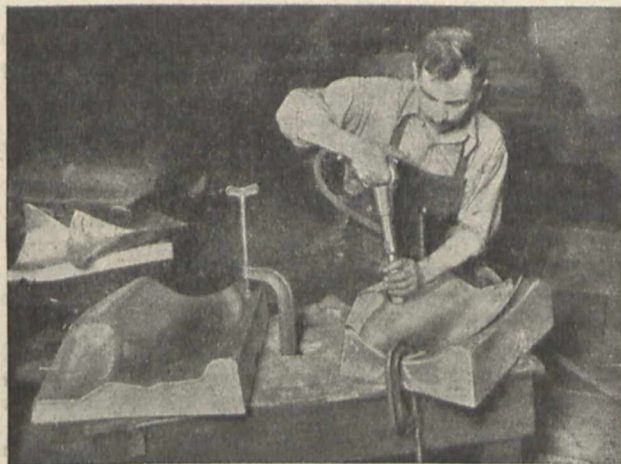
Rys. 2. Wyginanie blach ręcznym młotkiem pneumatycznym na formie cynkowej, służącej jako wzornik.
