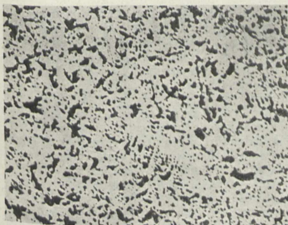
Rys. 17. Mikrobudowa stopu Cu-Pb o 30% Pb.
