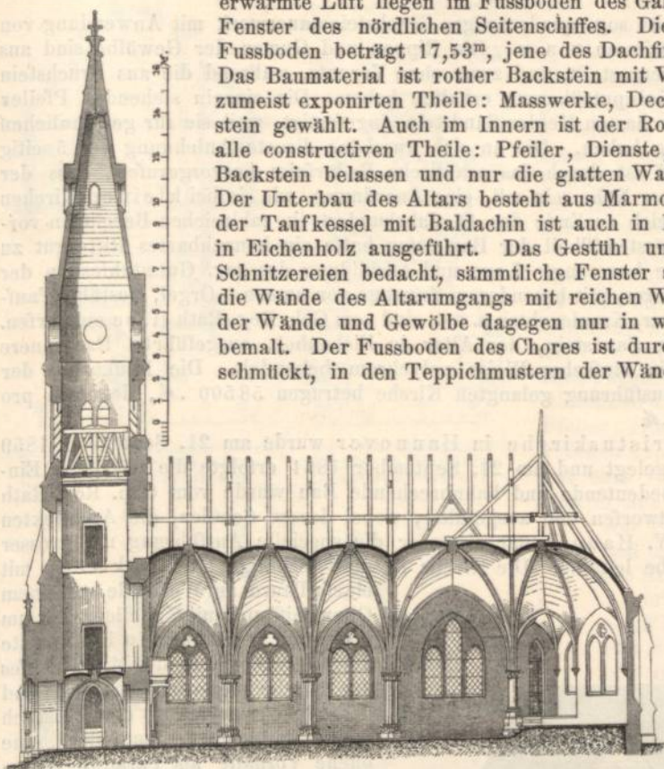
Fig. 1746. Kirche zu Astfeld bei Goslar. Längenschnitt (Architekten W. Luer und C. Hase).
