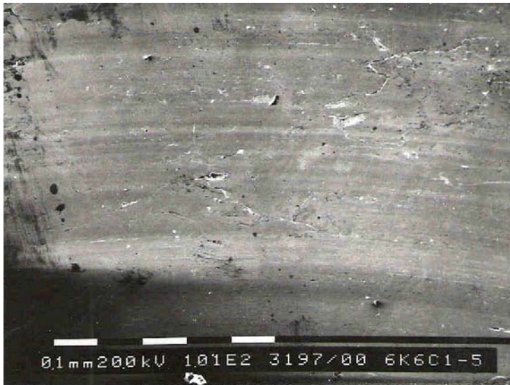
Rys. 47. Widok powierzchni kulki stałej po pracy przy obciążeniu F = 500 daN, smarowanej kompozycją z 6%PTFE+6% Cu – pow. \times 101
