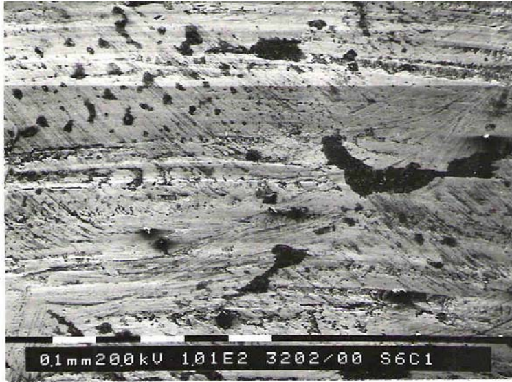
Rys. 46. Widok powierzchni kulki stałej po pracy przy obciążeniu F = 126 daN, smarowanej kompozycją z 6% Cu – pow. \times 101
