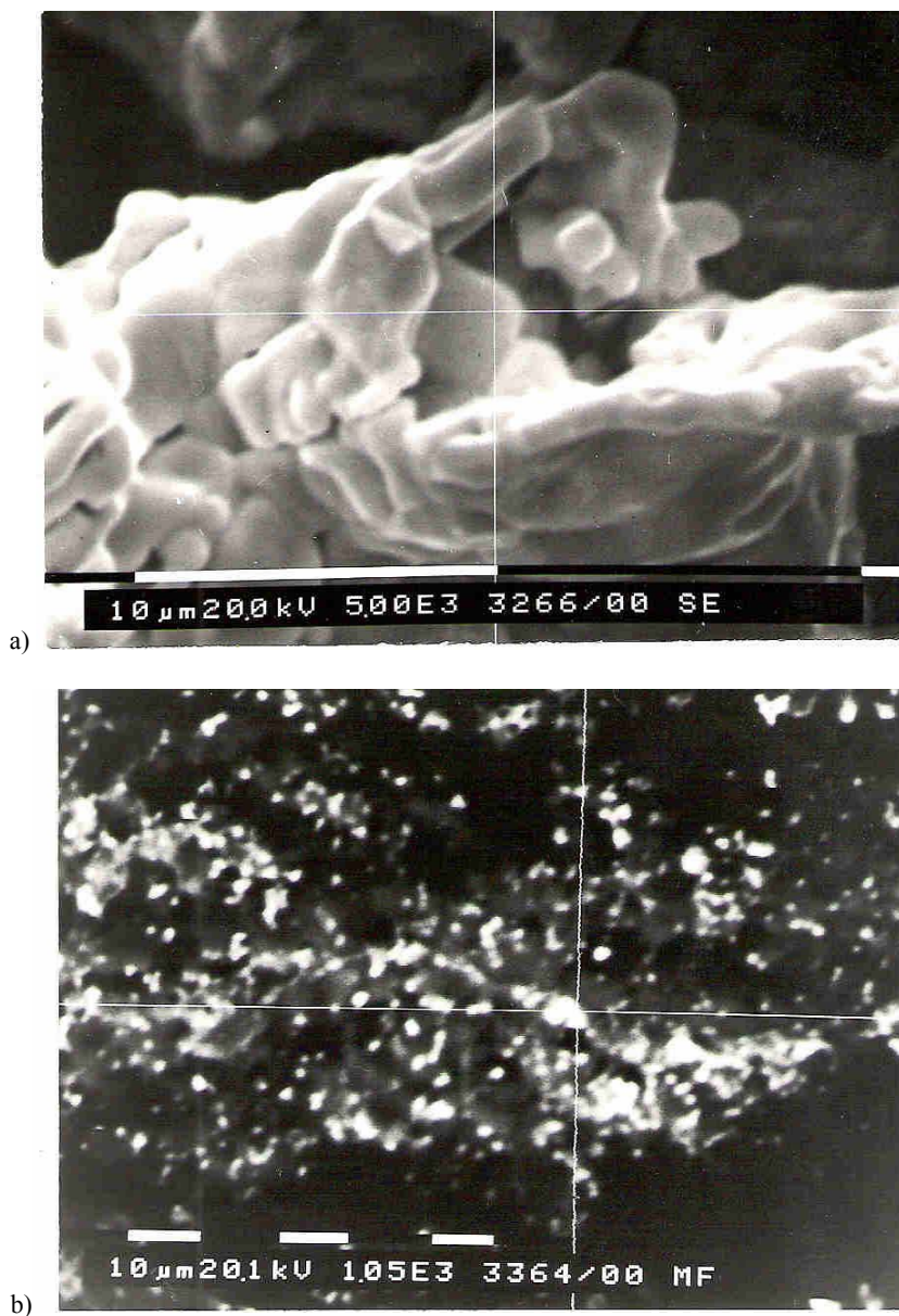
Rys. 52. Wygląd pozostałości po termicznej analizie różnicowej z: a) mieszaniny PTFE + Cu, b) kompozycji z 6% PTFE + 6% Cu
