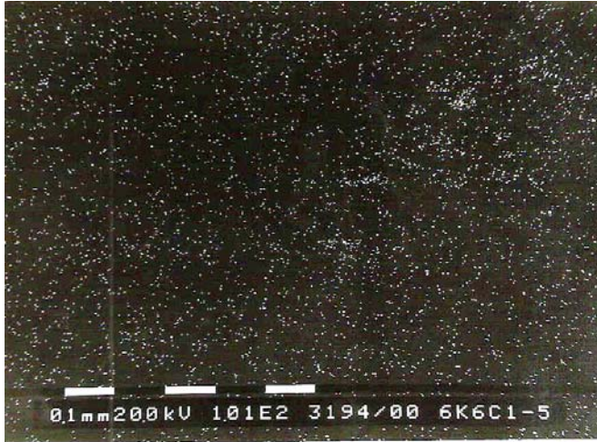
Rys. 61. Rozkład miedzi na powierzchni tarcia kulki stałej smarowanej kompozycją z 6% PTFE + 6% Cu
