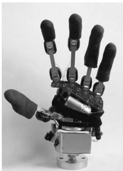
Rys. 2.1. Sztuczna dłoń, w której wykorzystany został układ mikrohydrauliczny [2.7]
