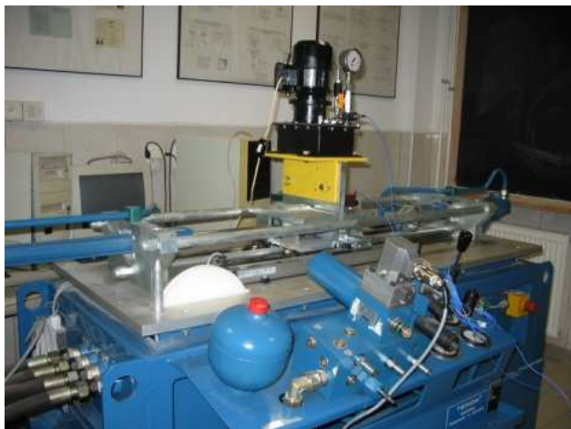
Rys. 9.22. Symulator liniowego napędu hydrostatycznego jako źródło drgań mechanicznych
