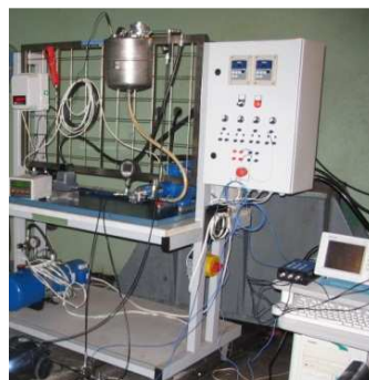
Rys. 9.10. Układ mikrohydrauliczny, w którym pracował badany mikroawór przelewowy
