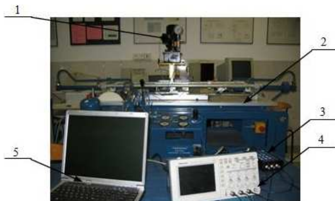
Rys 9.27. Stanowisko badawcze: 1 – obiekt badań (mikrozasilacz hydrauliczny), 2 – generator drgań mechanicznych (symulator Hydropax ZY-25), 3 – kondycjoner sygnału pomiarowego z czujników ciśnienia i drgań, 4 – oscyloskop cyfrowy TDS 224, 5 – komputer przenośny
