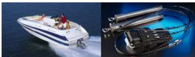
Rys. 2.6. Motorówka z napędem mechanizmu steru wyposażonym w mikroukład hydrostatyczny [2.10]
