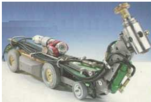
Rys. 2.3. Robot kanałowy przeznaczony do naprawy i remontu rur ściekowych [2.10]
