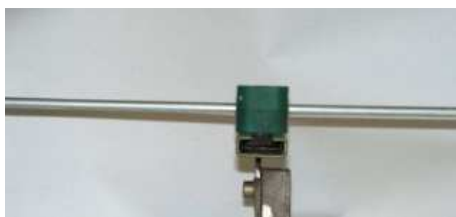
Rys. 9.44. Mikroprzewód hydrauliczny utwierdzony w połowie długości
