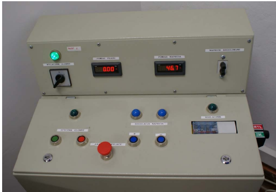
Rys. 6.4. Pulpit sterowniczy do regulacji i pomiaru napięcia zasilającego.
