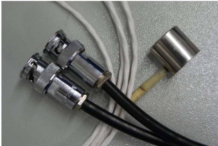
Rys. 6.5. Przetwornik piezoelektryczny stykowy WDAH17 firmy PAC z wtykami przyłączeniowymi.
