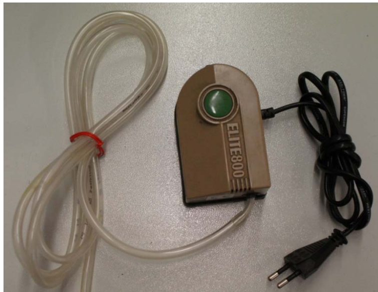
Rys. 6.2. Widok kompresora zastosowanego do zasilania aeratora.
