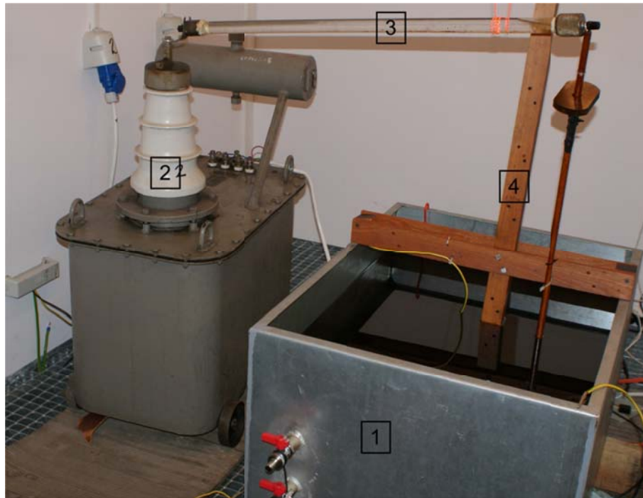
Rys. 6.3. Widok zastosowanego układu pomiarowego, gdzie: 1-kadź pomiarowa, 2-transformator probierczy, 3-opornik wodny, 4-układ mocujący iskiernik modelujący WNZ.
