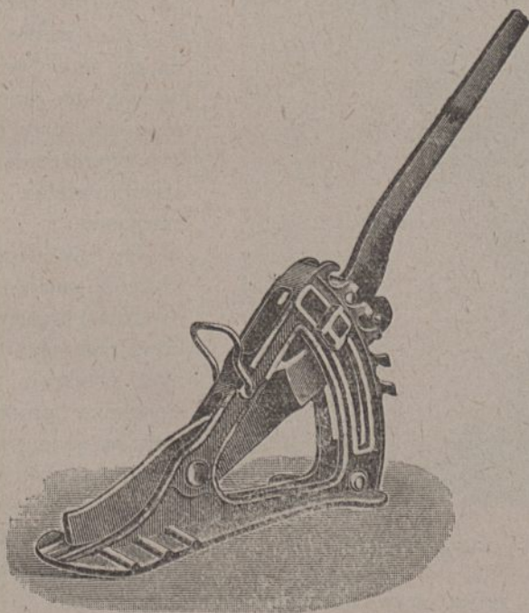
Rys. 105 b. Dźwigarka torowa.
