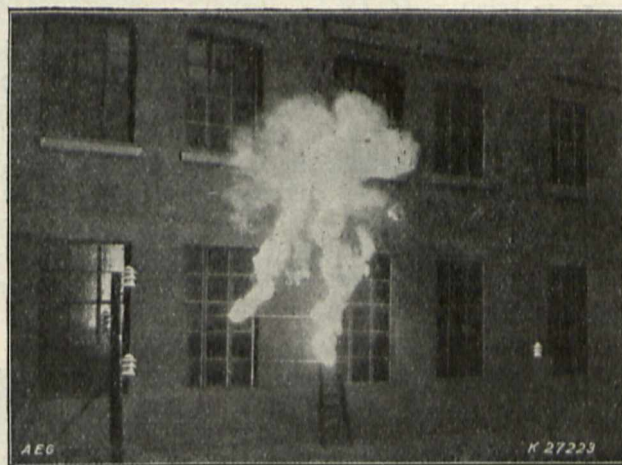
Rys. 8. Trójfazowe zwarcie łukowe w sieci 45 kV.
