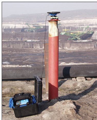
Fot. 1. Pomiar metodą statyczną GPS na punkcie sieci przestrzennej nr 5113
