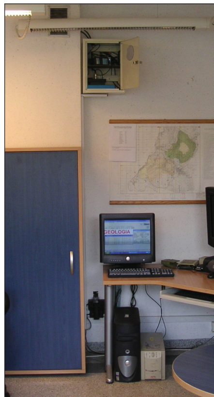
Fot. 3. Odbiornik stacji referencyjnej i komputer zarządzający Phot. 3. The receiver in the reference station and the controller computer
