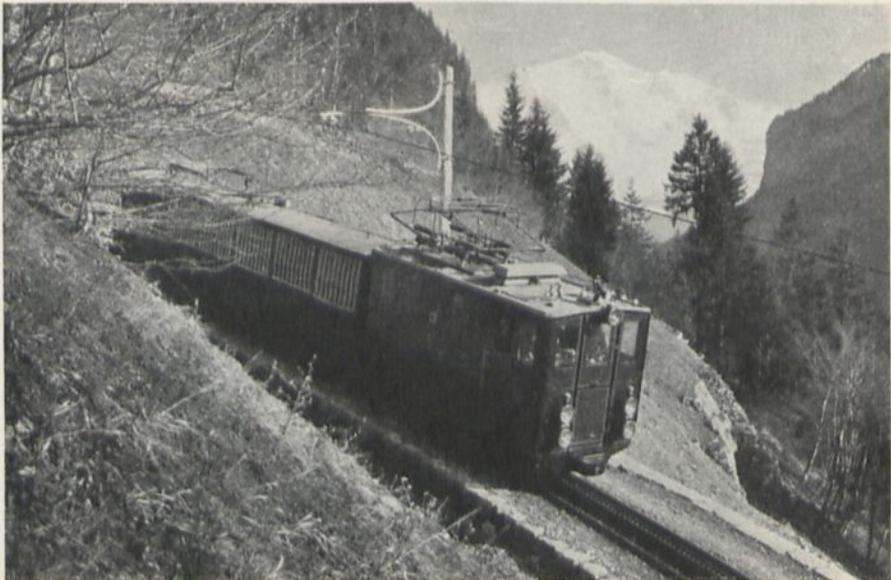
Abb. 95. Zug der Schynige-Platte-Bahn mit offenen Personenwagen.
