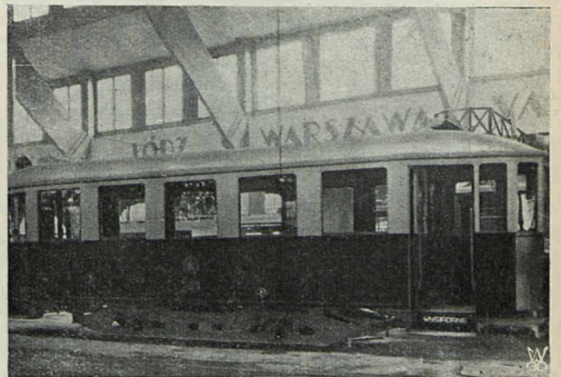
Rys. 12. Pierwszy wagon tramwajowy w Polsce, całkowicie żelaznej konstrukcji.
