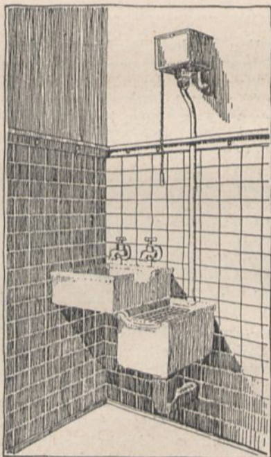
Abb. 206. Schmutzausguß und Wasserzapfstelle im Reinmacheraum
