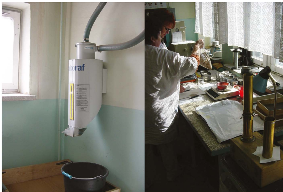
Fot. 3. Podstawowe wyposażenie i czynności w laboratorium badawczym: a) odbiór próby; b) badania gęstości nasypowej
