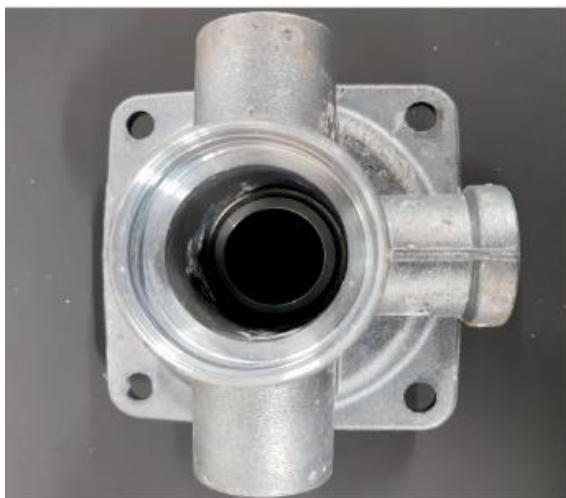
Rys. 85. Stan powierzchni korpusów pomp odlanych ze stopu Al231 z powłokami konwersyjnymi osadzonymi bez oraz w obecności od 200 ppm do 800 ppm cyrkonu, po 240 h testu NSST [81].
