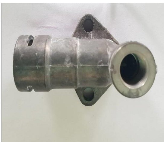
Rys. 69. Stan powierzchni elementów pomp odlanych ze stopu Al226 bez powłoki ochronnej, z zastosowaniem tylko „bazy” oraz z powłokami konwersyjnymi osadzonymi w obecności bazy z dodatkami Zr, Ti, Co i V po 240 h testu NSST. Oznaczenia kąpiel, w których poddano obróbce poszczególne detale podano bezpośrednio przy zdjęciach.
