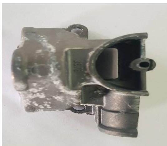
Rys. 68. Stan powierzchni elementów pomp odlanych ze stopu Al231: bez powłoki ochronnej, z zastosowaniem powłoki otrzymanej w kąpeli bazowej oraz z powłokami konwersyjnymi osadzonymi z kąpeli bazowej z dodatkami Zr, Ti, Co i V po 240 h testu
