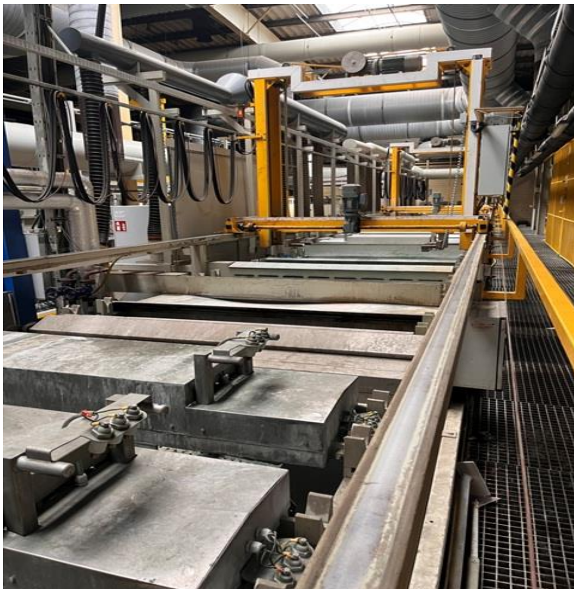
Rys. 87. Automatyczna linia galwaniczna do pasywacji aluminium z obrotowym systemem zawieszkowym.
