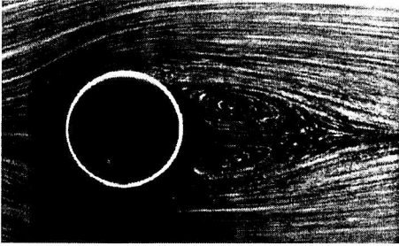
Rys. 6.29: Wizualizacja opływu walca strumieniem jednorodnym, gdy liczba Reynoldsa Re = 26 [25]
