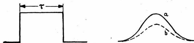
Rys. 2 Zniekształcenie impulsu w odbiorniku
