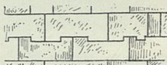
Steinverband des Mauerwerkes. Kathedrale zu Bosra 78) .
