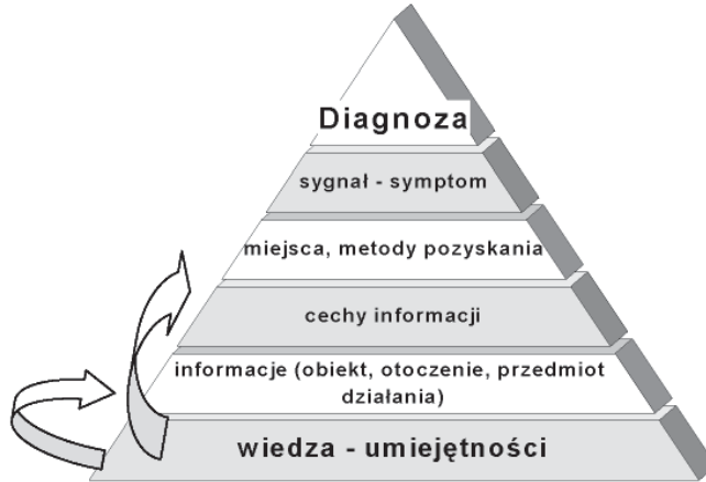
Rys. 2.1. Hierarchia budowy systemu diagnostycznego
