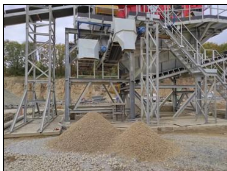
Rys. 8. Testy na wapieniu 8–16 mm foremne (z prawej) i nieforemne (z lewej) Fig. 8. Limestone tests 8–16 mm regular grains (right) and irregular (left)
