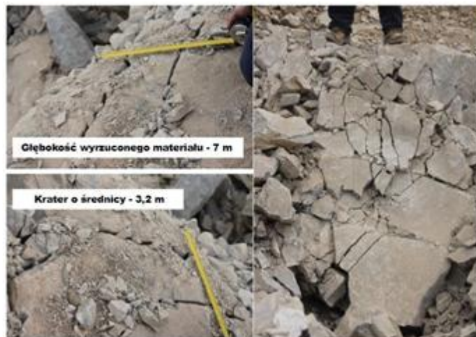
Rys. 2. Wynik próby 1 dla pojedynczego otworu (Araos & Onederra 2015) Fig. 2. Test 1 result for single hole (Araos & Onederra 2015)
