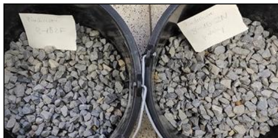
Rys. 10. Produkt finalny: piaskowiec 8–16 mm foremny (z lewej), nieforemny (z prawej) Fig. 10. Final product: sandstone 8–16 mm regular (left), irregular (right)
