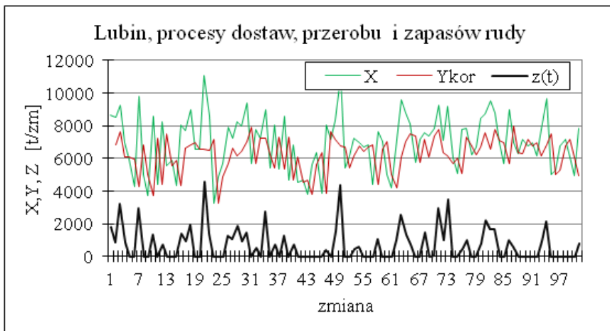
Rys. 12. Symulacja zapasów rudy jako funkcja dostaw i przerobu losowo zmiennych wg rozkładów jak na rysunku 11 i w tabeli 2 (wycinek dla 100 zmian; uzyskane X_{sr} = 6943 ; Y_{sr} = 6129 )
